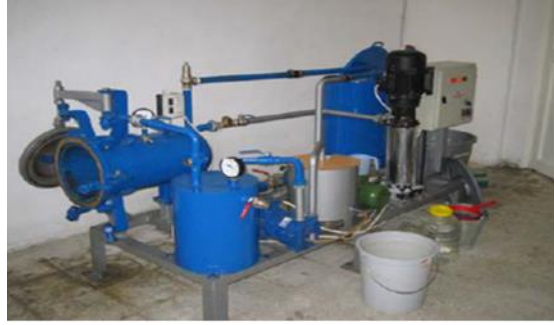
Şekil 5. Emprenye Deney Düzenegi (Baysal ve ark., 2003)
