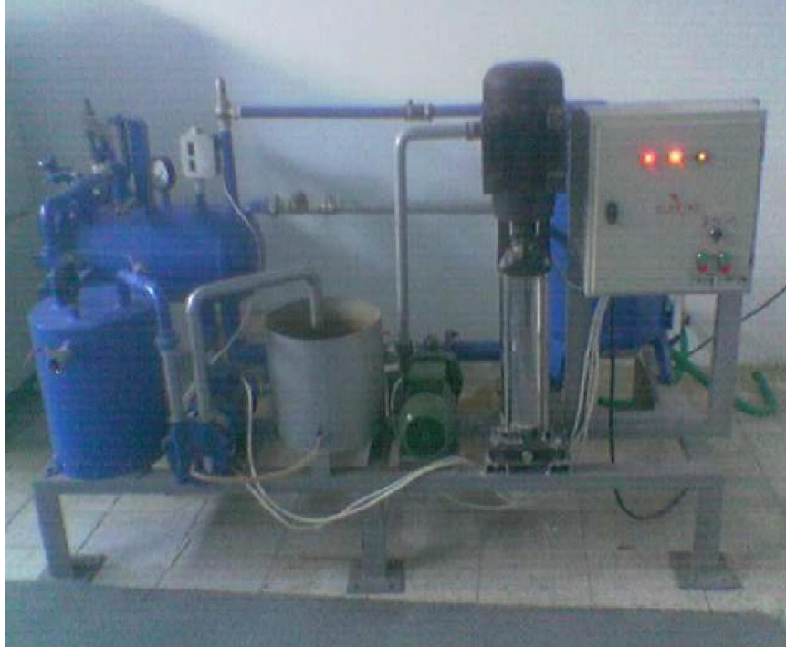
Şekil 5. Emprenye düzeneği (Baysal ve ark., 2003)
