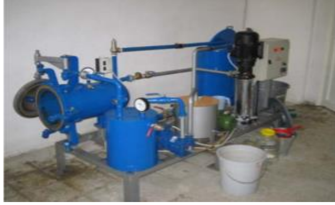
Şekil 2. Emprenye Deney Düzenegi (Baysal ve ark., 2006)
