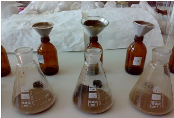
Şekil 6. İnkübe edilmiş toprak numunelerinin süzdürülme işlemi
