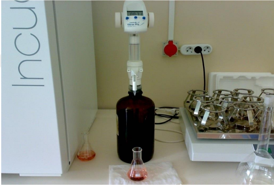
Şekil 8. Destile edilen örnekler üzerinde titrasyon işlemi
