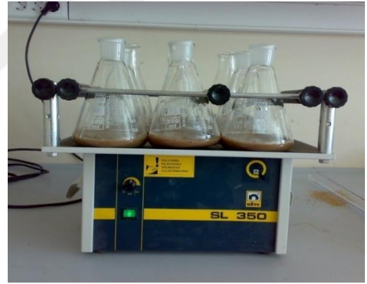
Şekil 5. İnkübe edilmiş toprak numunelerinin tartılması ve çalkalanması
