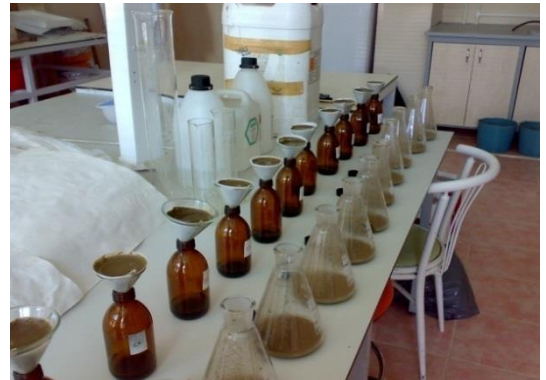
Şekil 6. İnkübe edilmiş toprak numunelerinin süzdürülme işlemi
