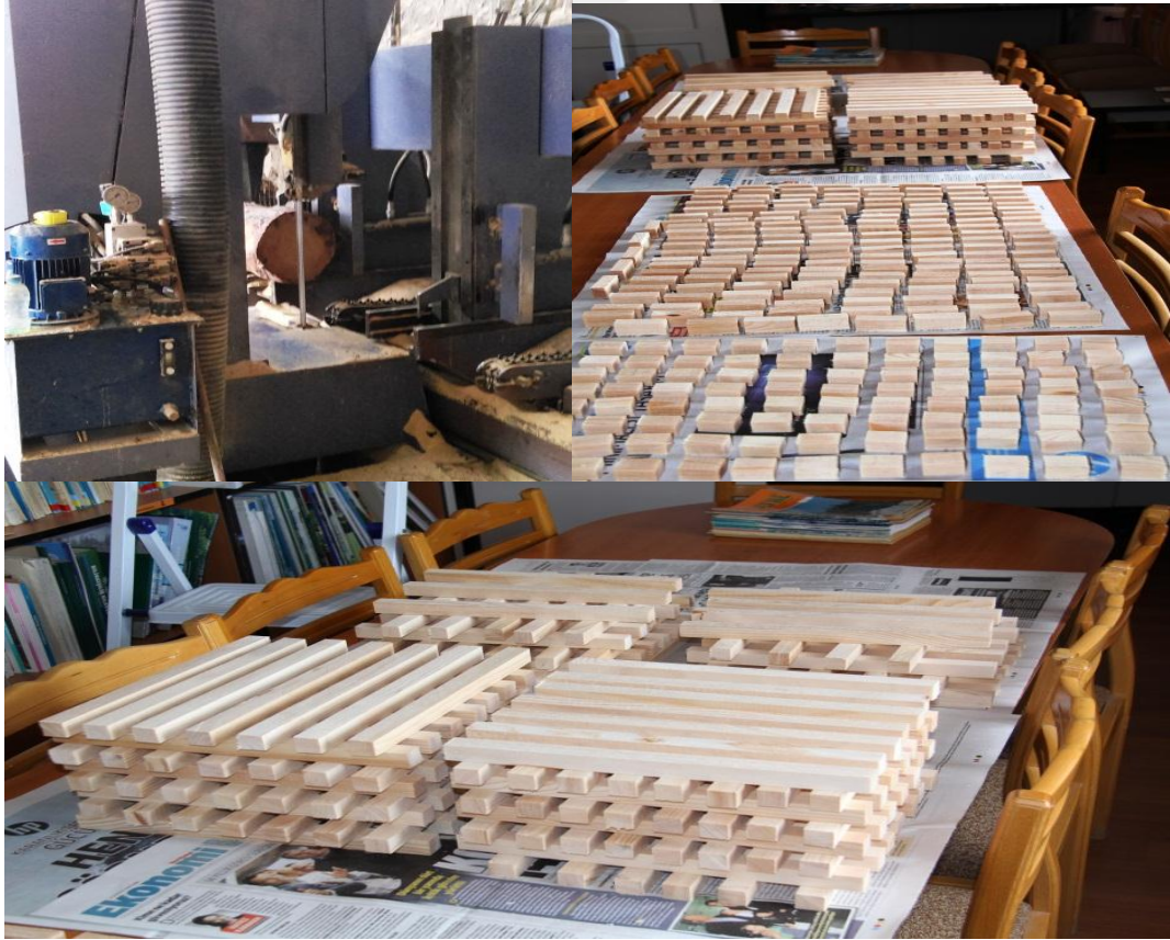
Şekil 5. Mekanik Testler için numunelerin hazırlanması
