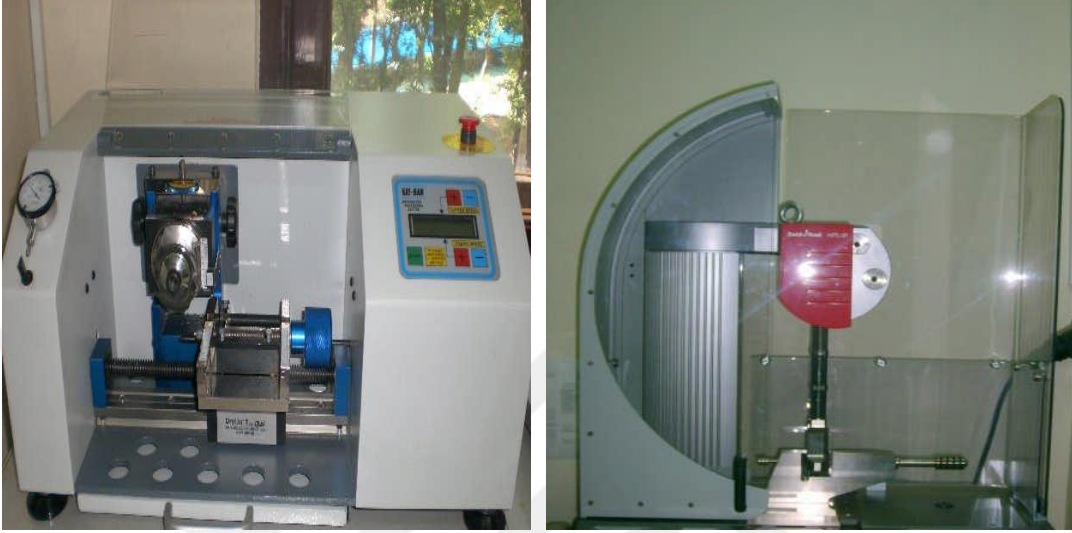
Şekil 16. Polytest RayRan çentik açma aleti ve Zwick/Roell HIT5.5P. Darbe test cihazı.
