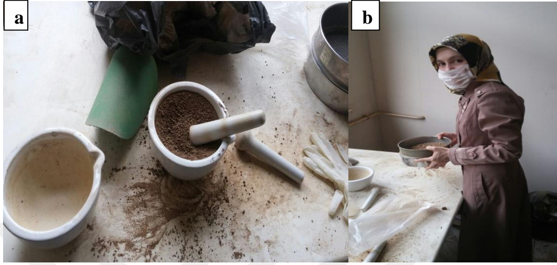
Şekil 9. (a) Toprakların Porselen Havanda Öğütülmesi, (b) Toprakların 2mm'lik Elekten Elenmesi
