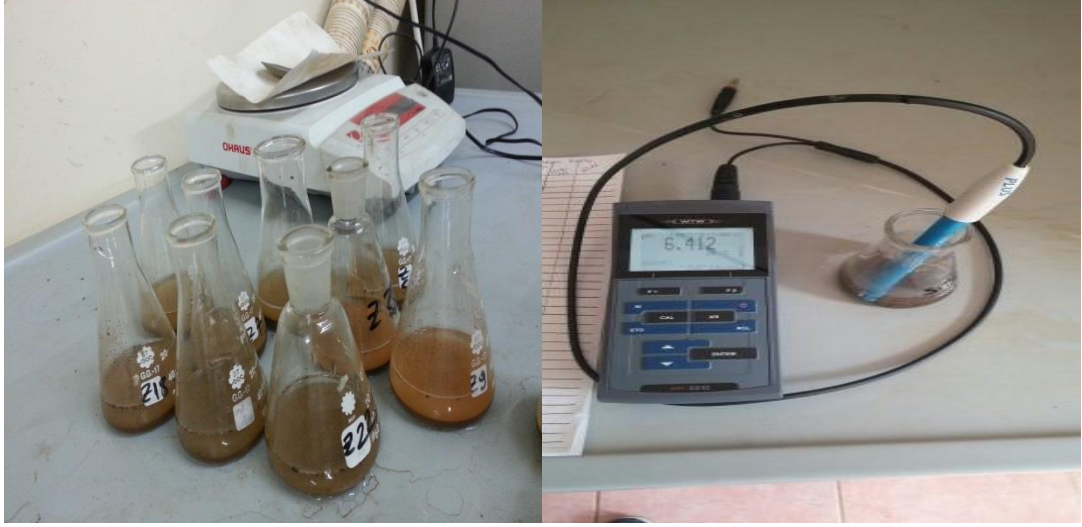
Şekil 8. Toprak pH ölçümü yapılırken bir görünüm
