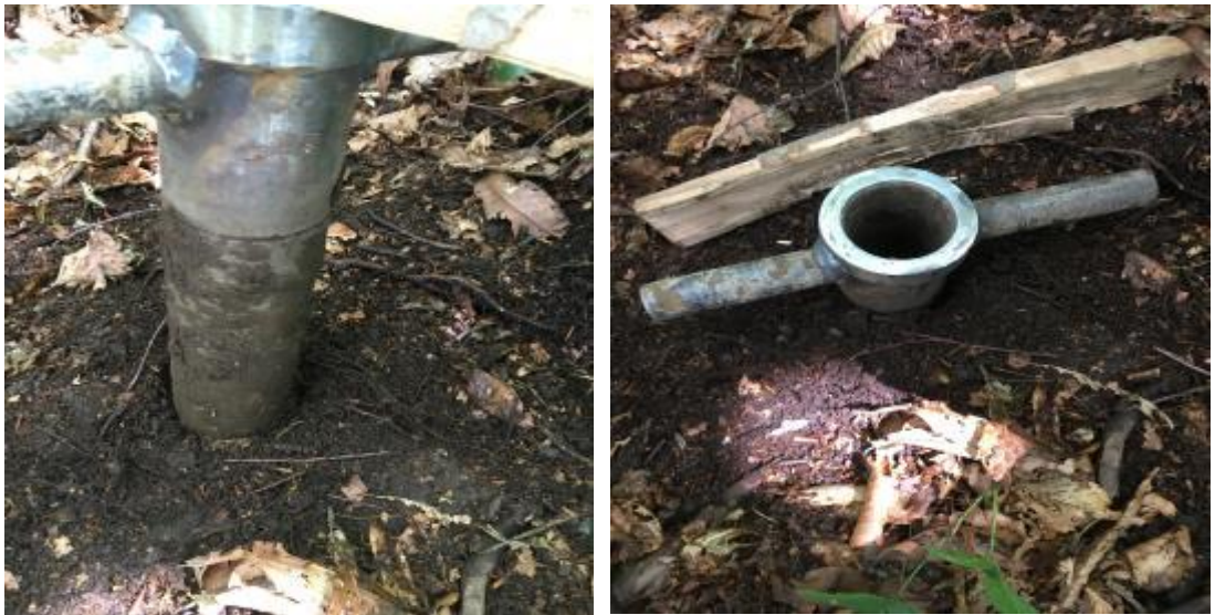
Şekil 2. Kök örneklerinin alındığı çelik boru
