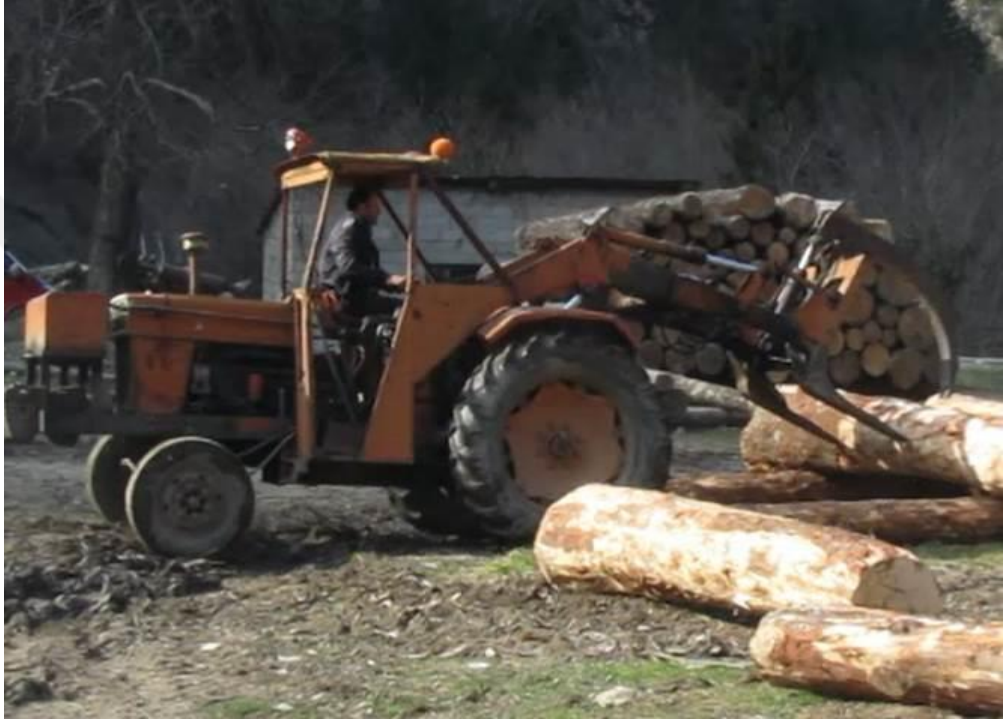
Şekil 19 İş makinesinin güvenlik donanımlarının olmaması
