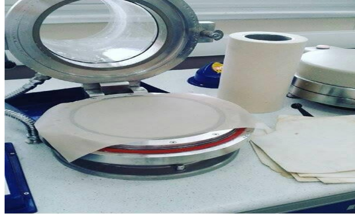
Şekil 4. Optik testler için test kâğıdı hazırlama işlemi.
