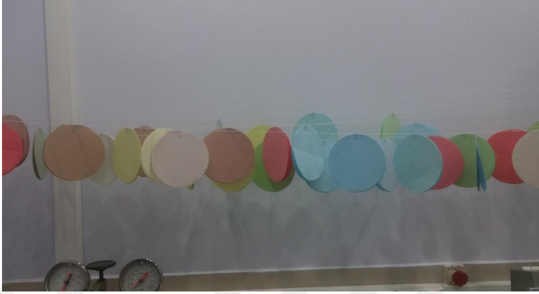
Şekil 6. Fiziksel analizler için test kâğıtlarının şartlandırılma aşaması.
