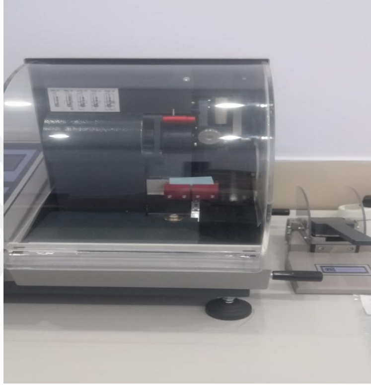
Şekil 8. Fiziksel testlerin ölçümünde yapılan yırtılma test çalışması.
