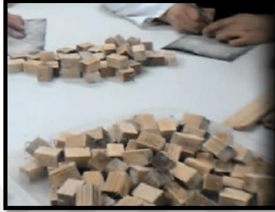
Şekil 3. Uygulanan Zımpara İşlemi
