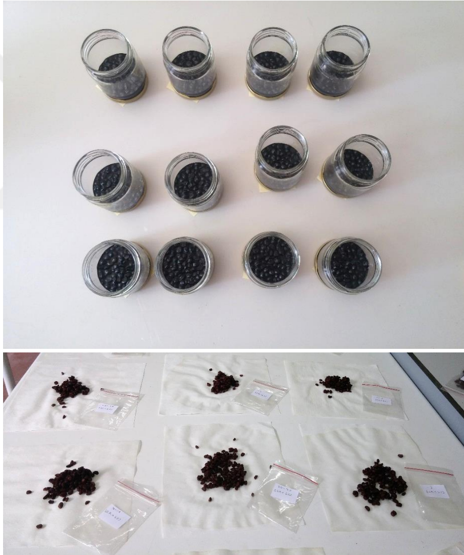
Şekil 7. Sülfürik asitte bekletme ön işleminin uygulanması
