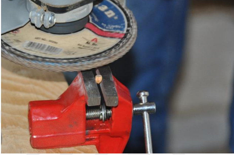
Şekil 4. Kabuk kalınlığı ölçümü için tohumların zımparalanması
