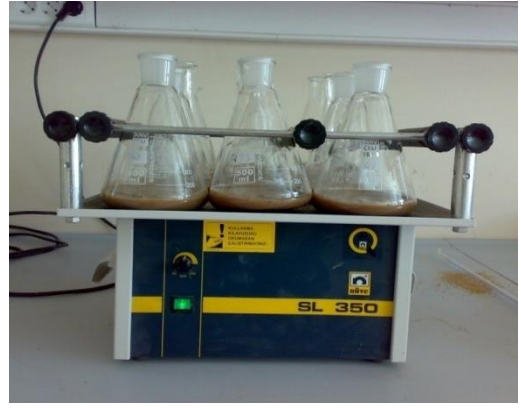
Şekil 5. İnkübe edilmiş toprak numunelerinin tartılması ve çalkalanması
