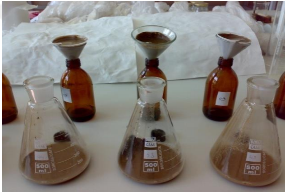
Şekil 6. İnkübe edilmiş toprak numunelerinin süzdürülme işlemi
