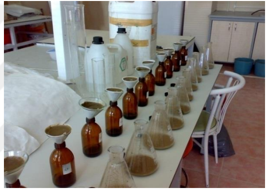
Şekil 6. İnkübe edilmiş toprak numunelerinin süzdürülme işlemi
