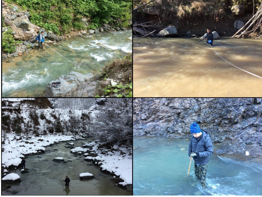
Şekil 13. Deredeki su akım hızının ve en kesitinin ölçülmesi (Foto: Şenol Osmanaoglu)
