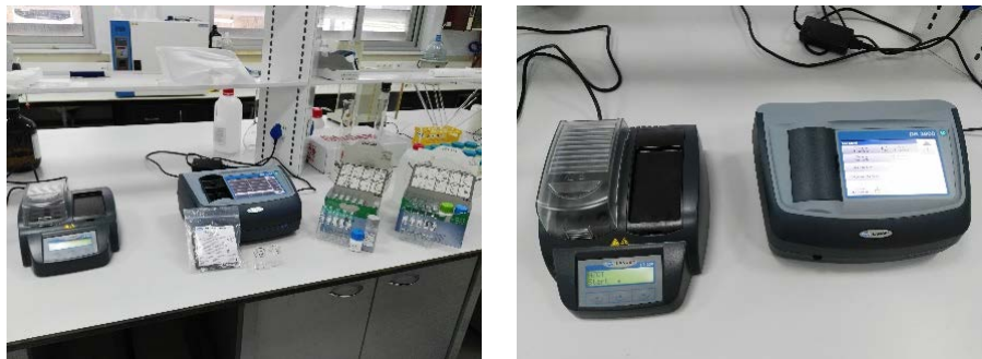
Şekil 17. Hach Lange küvet testleri ile spektrofotometrede ölçüm yapılması (Foto: Saim YILDIRIMER)
