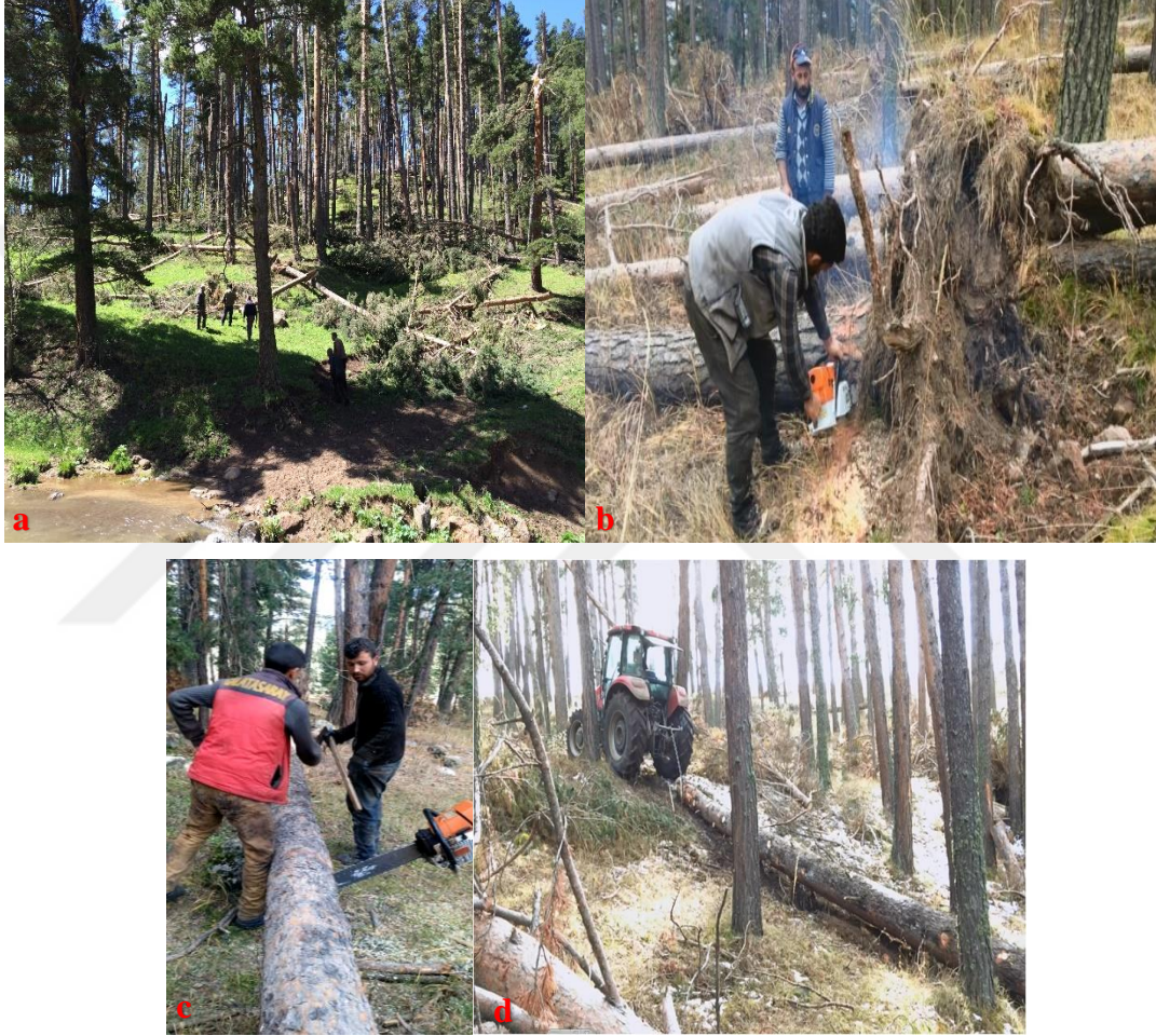
Şekil 8. Çalışma alanında ormancılık üretim işleri (a, b, c, d) a) Çalışma alanındaki sarıçam devrikleri b) Devrik ağaç kök kesimi c) Sıkışan motorlu testerenin balta yardımıyla kurtarılması d) Sıkışan motorlu testerenin traktör yardımıyla kurtarılması
