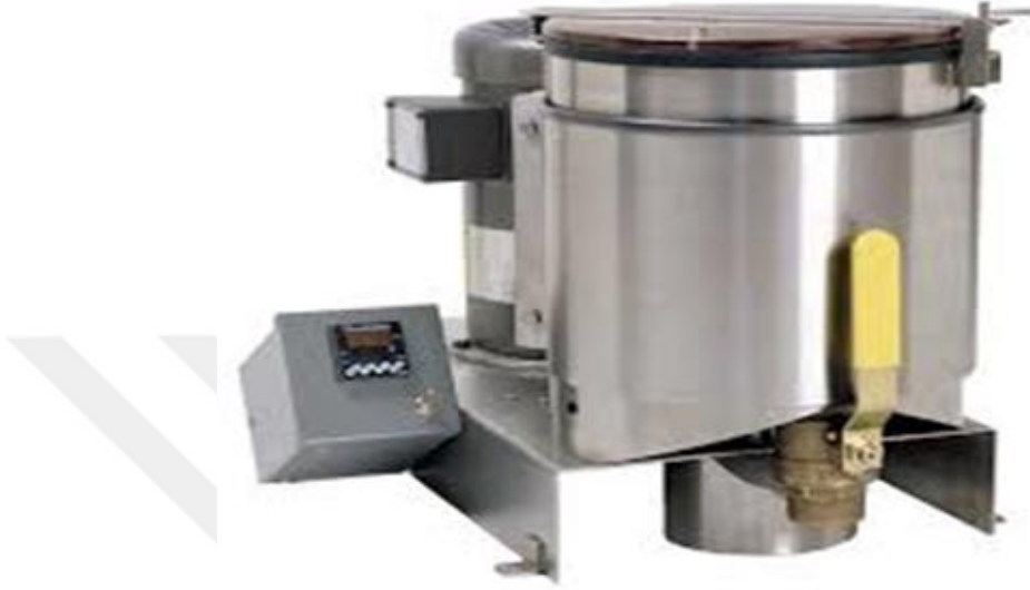
Şekil 1. Isıtma ceketli laboratuvar tipi hamurlaştırıcı (Pulper).
