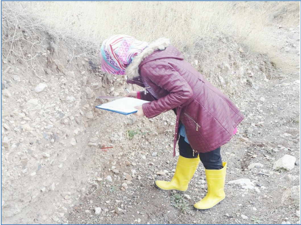
Şekil 7. Erozyon çubuk ölçümü; demir çubukların açıkta kalan (toprak dışında) uzunluklarının ölçümü
