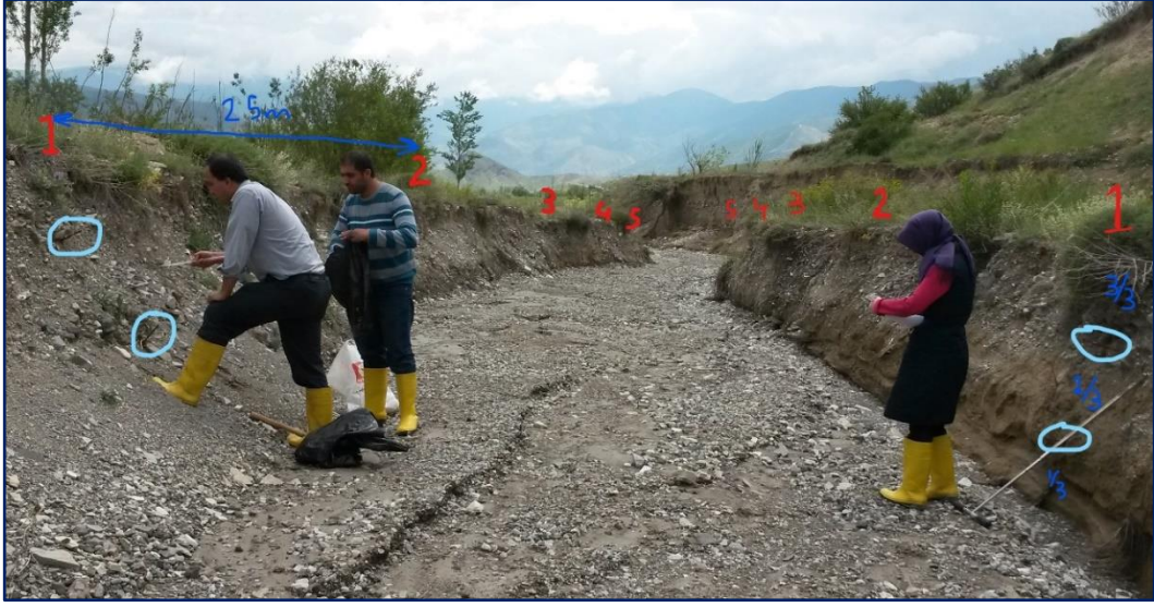
Şekil 6. 100 m'lik oyuntu deresi üzerinde 25 metre aralıklarla belirlenen 5 transekt noktası (kırmızı renkte) ve bu noktalar/kesitin bulunduğu şevler üzerindeki erozyon çubuklarının (açık mavi renkte) konumu
