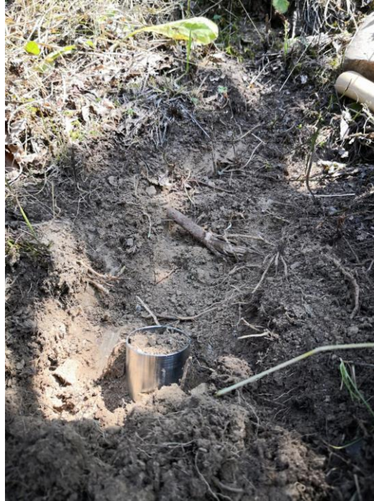
Şekil 12. Çalışma sahası bozulmamış toprak örneği alımı görüntüsü
