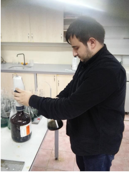
Şekil 18. Organik maddenin belirlenmesinde titrasyon aşaması
