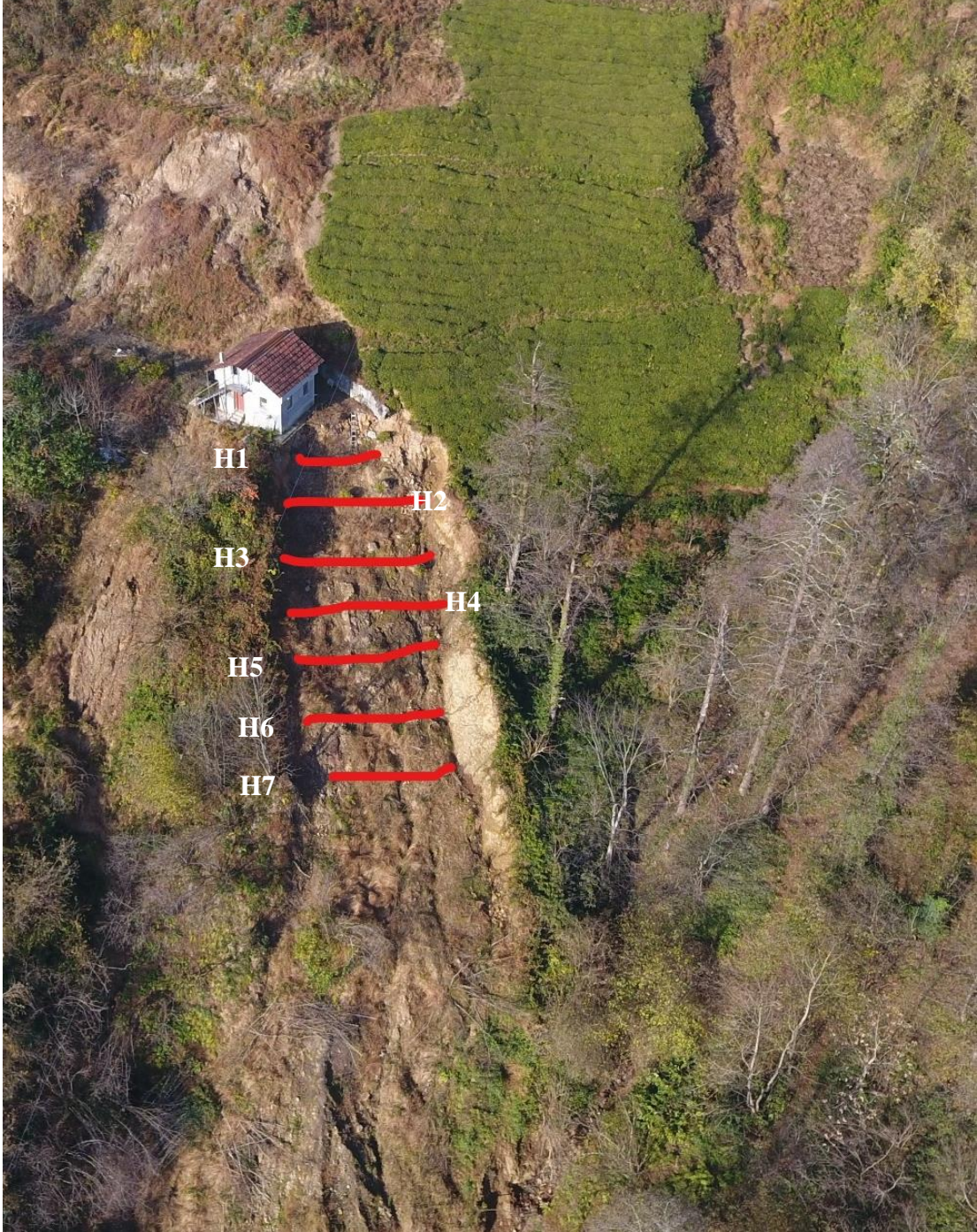
Şekil 24. Kopan heyelan bölgesi üzerinden alınan yeraltı görüntüleme radarı güzergâhları Tüm arazi kullanımlarındaki verileri Georadar'ın 500 MHz'lik korumalı anteni ile alınmıştır (Şekil 25).
