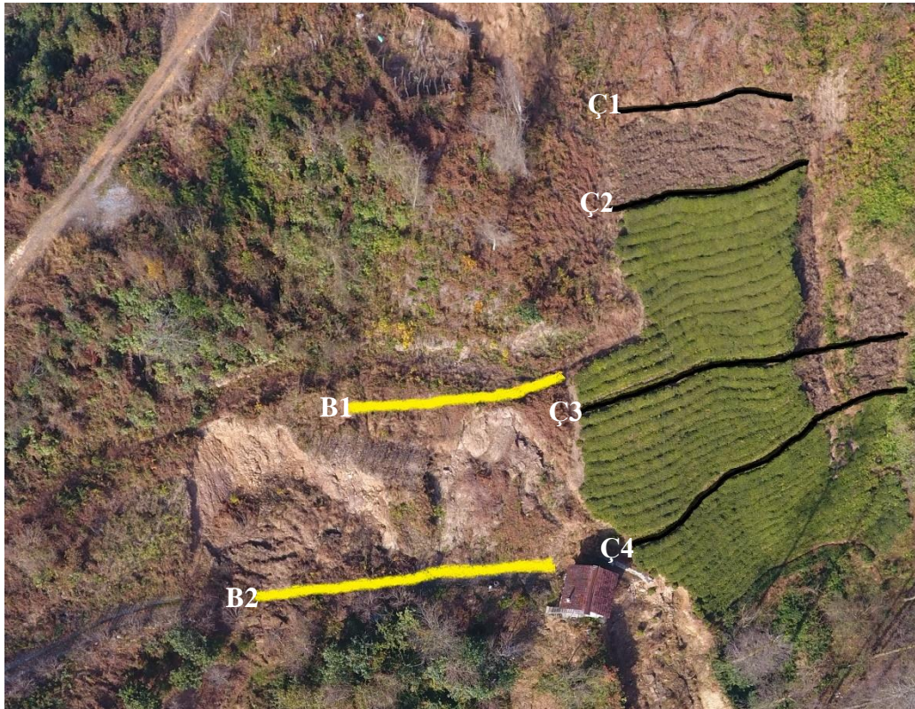
Şekil 23. Çay ve boş alanda yeraltı görüntüleme radarı için belirlenen güzergâhlar
