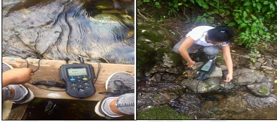
Şekil 7. Su kalitesi parametrelerinin YSI cihazı ile yersel ölçümü
