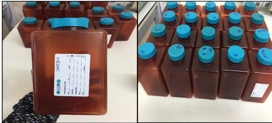
Şekil 8. Askıda Katı Madde analizi için su örneklerinin alınmasında kullanılan plastik kaplar
