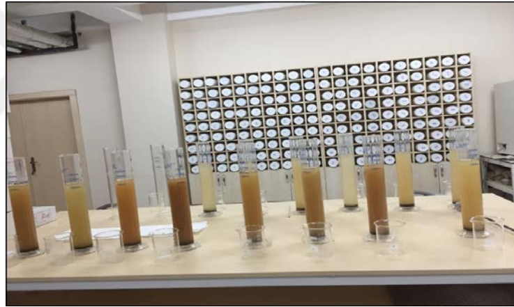
Şekil 13. Bouyoucos silindirinde tekstür tayini aşaması.
