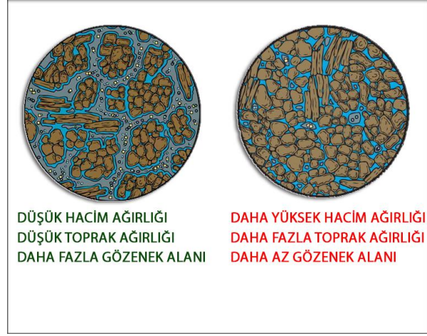
Şekil 1. Toprak sıkışmasının şematik gösterimi
