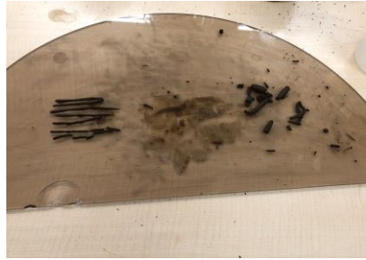
Şekil 9. Plastik limit belirleme yöntemi
