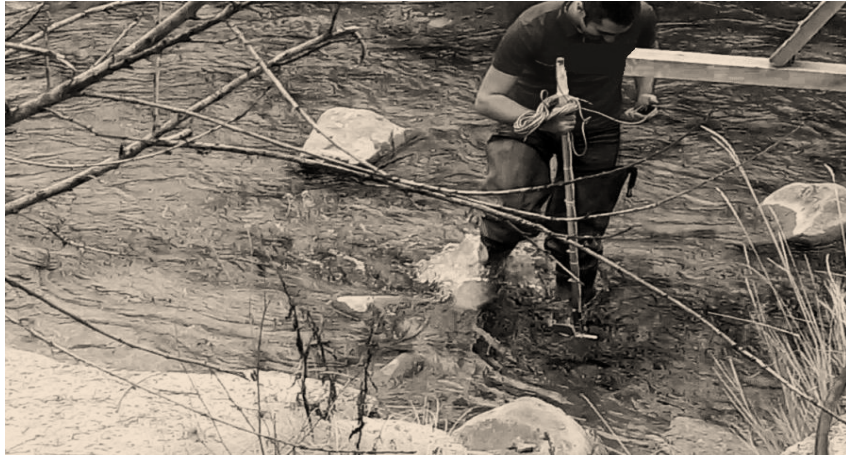
Şekil 24. Akış Ölçer ile Hız/Debi Ölçümü
