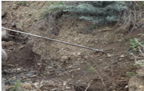
Şekil 20. Silindirik Toprak Numunesi Alımı
