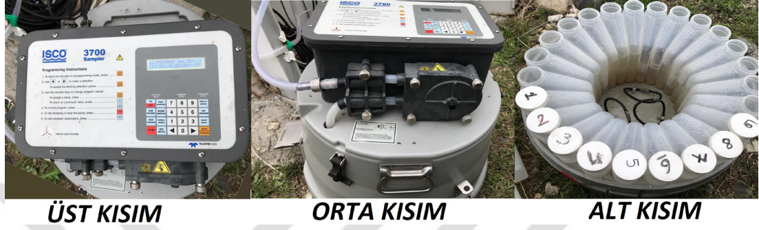
Şekil 21. ISCO Sampler 3700 Cihazının Görünümü
