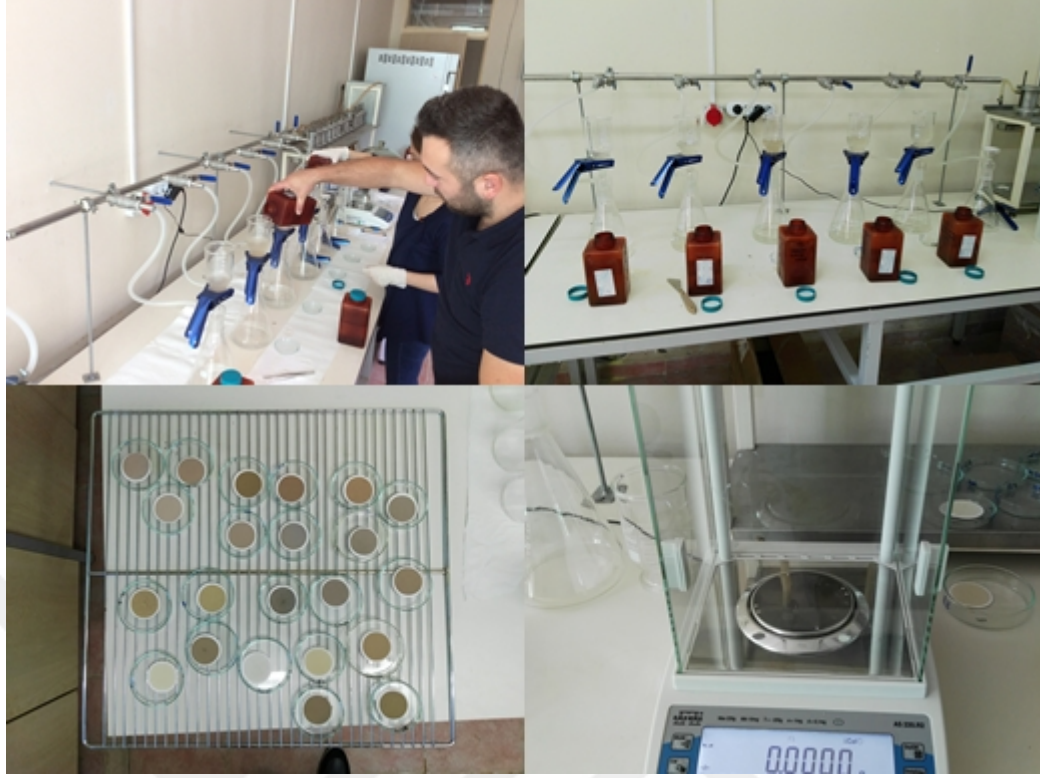
Şekil 9. Su numunelerinin AKM tayini için filtrasyon, fırınlanma ve tartım aşamaları
