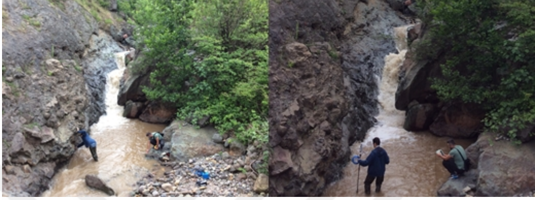
Şekil 7. Dere en kesitinin ve akım hızının ölçümü
