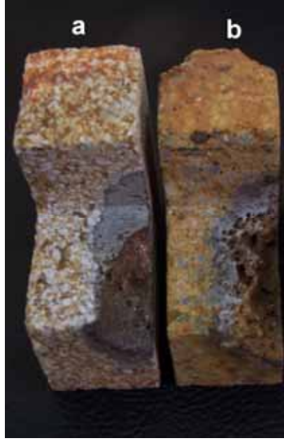
Şekil 3.107. Alternatif tuğla seçeneklerinde korozyon derinlikleri.
