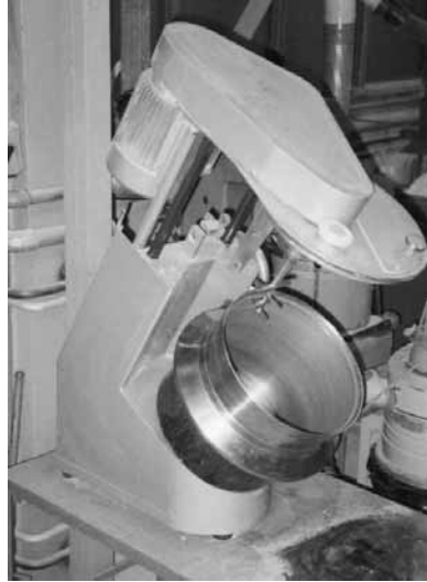
Şekil 2.3. Taşıyıcı tane ve bağlayıcı fazın karıştırıldığı Eirich tip karıştırıcı.
