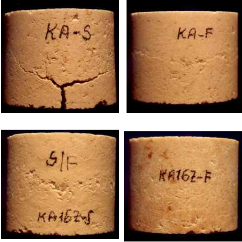
Şekil 3.94. Alkali buharı test sonuçlarının karşılaştırması.
