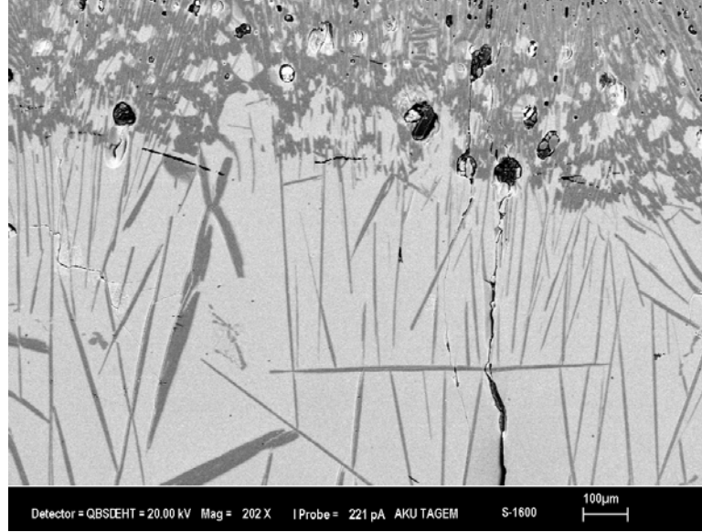
Şekil 3.70. Mullit-Curuf reaksiyonu sonucu oluşan bölgeler.
