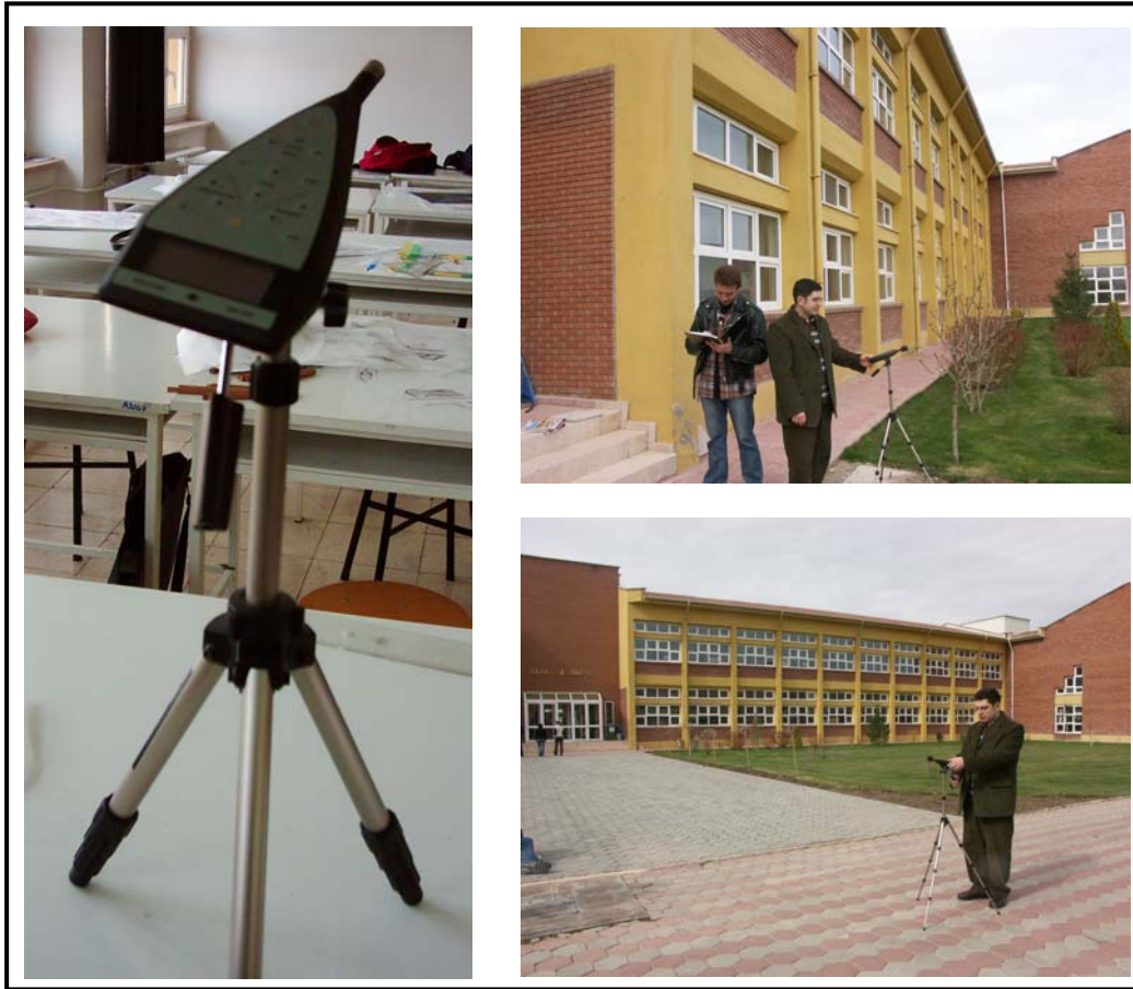
Şekil 4.17. Stüdyo 2 için yapı dışı gürültü düzeyi ölçmeleri
