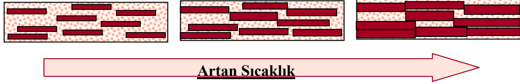
Şekil 4.2. Yönlendirilmiş çekirdeklerle kontrol edilen tane büyümesi (TGG) yöntemiyle yönlenmiş mikroyapı oluşumunun şematik gösterimi [57]
