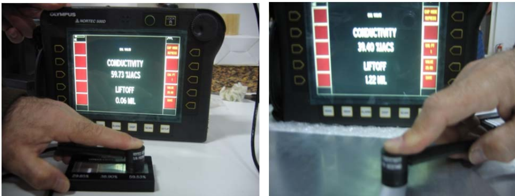
Şekil 5.11. Kaynaklı levhaya iletkenlik testi uygulanması
