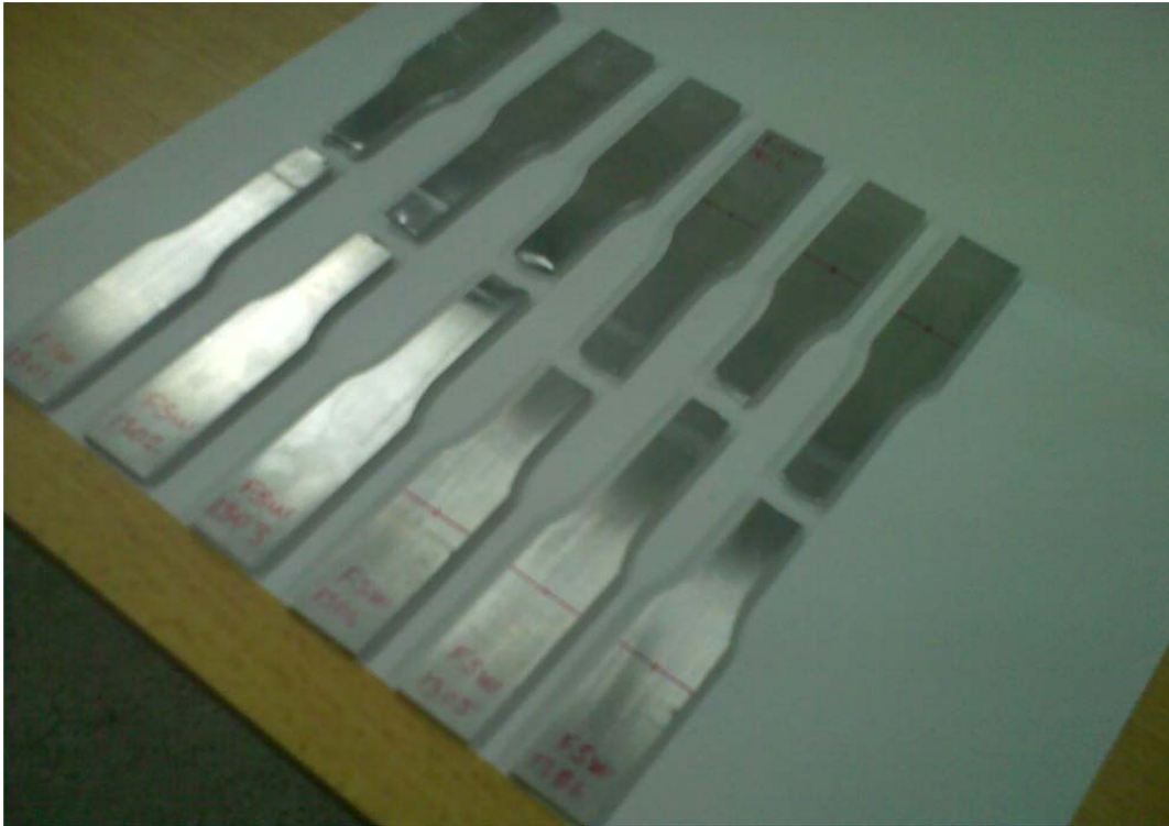
Şekil 6.8. Yorulma testleri sonucunda kopmuş numuneler ve kopmanın oluştuğu bölgelerin gösterimi
