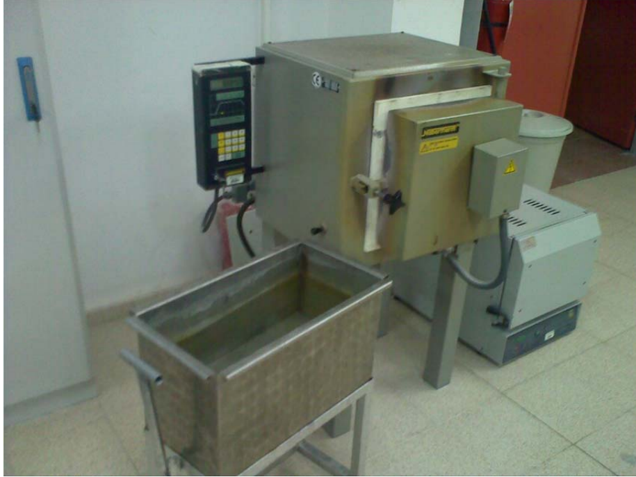
Şekil 5.12.b Numunelerin 550°C'deki fırından 6 saat sonra çıkartılması
