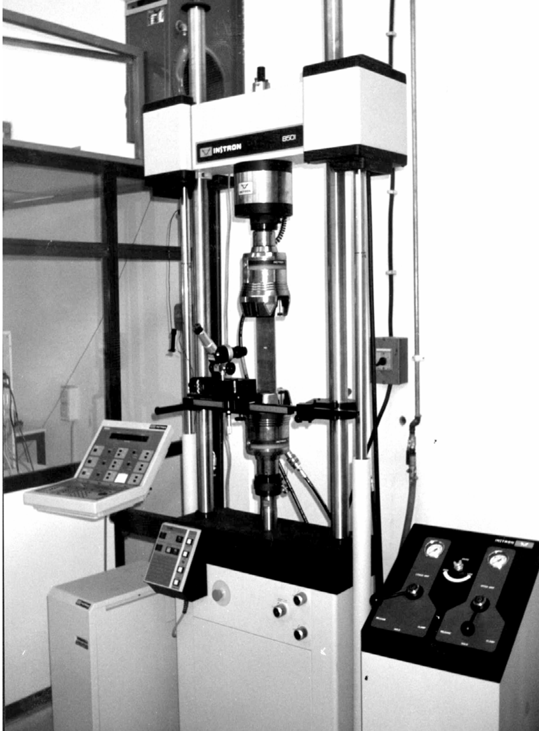
Şekil 5.6. Deneyde kullanılan Instron 8500 cihazı ve yardımcı teçhizatlar
