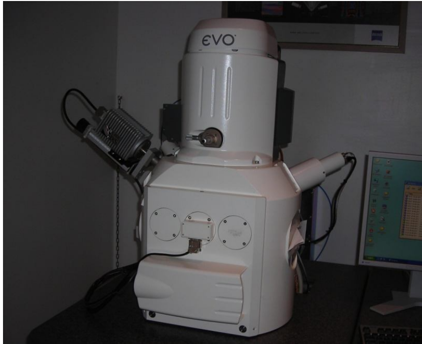
Şekil 4.9. SEM görüntüleri ve EDS sonuçlarının elde edildiği ZEISS EVO 50 E
