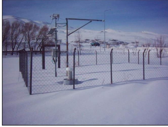
Şekil 2.7 Ultrasonik derinlik ölçerli Güzelyayla kar-meteoroloji istasyonu
