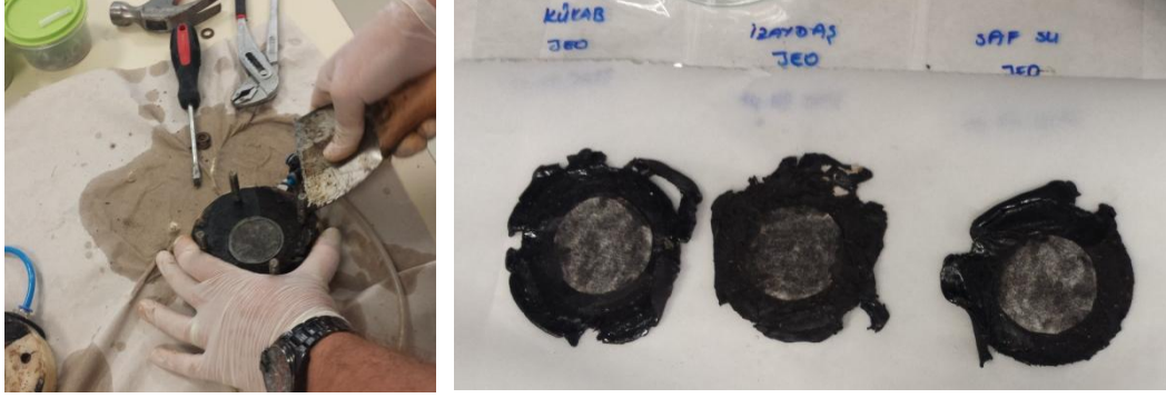
Şekil 5.23. Geomembranın molddan çıkartılması
