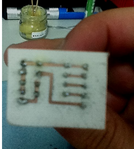
Şekil 5.13. 1/f gürültüsü ölçüm düzeneginin elektronik devre kartı
