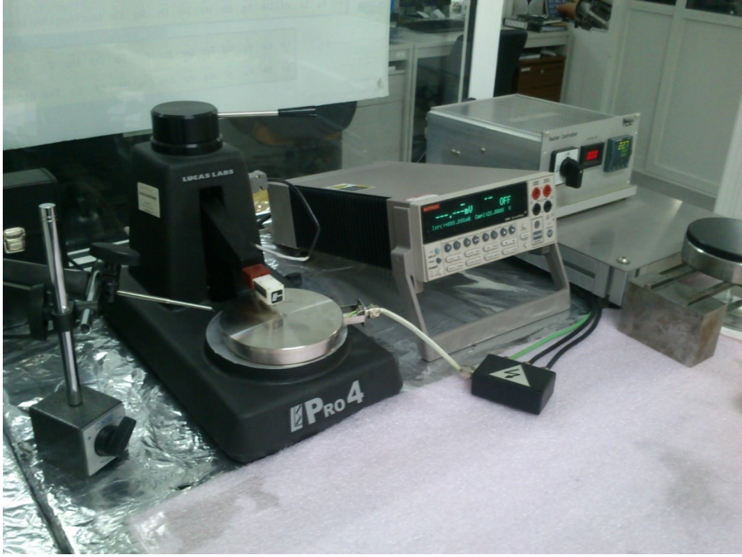
Şekil 6.7. Anadolu Üniversitesi İleri Teknoloji İnce Film Laboratuvarı'nda bulunan dört nokta iğne tekniği elektriksel ölçüm düzeneği
