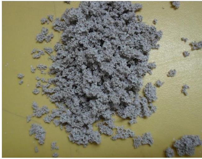
Şekil 4.2. Kütlece %8,2 peroksitin %0,59 oranında zeytinyağı eklenmesi sonucu oluşan köpük
