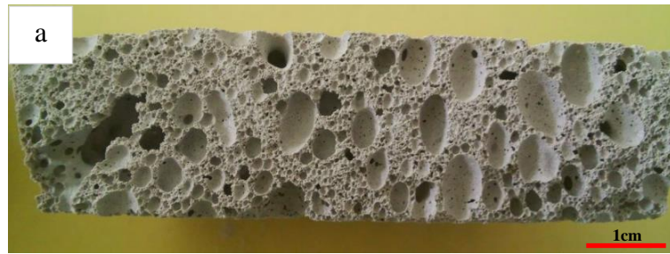
Şekil 4.18. Hegzilamin miktarının köpürme üzerine etkisi. Tüm numuneler kütlece % 6,8 peroksit ve a) hegzilamin kullanılmadan b) %0,7 c)%0,8 d)%0,85 hegzilamin içermektedir
