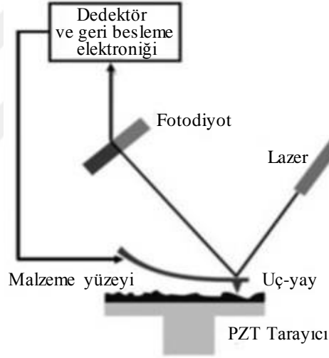
Şekil 5.13. AFM cihazının şematik gösterimi
