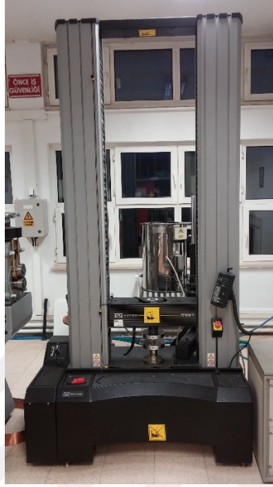
Görsel 3.12. Testlerde kullanılan Instron 5581 cihazı
