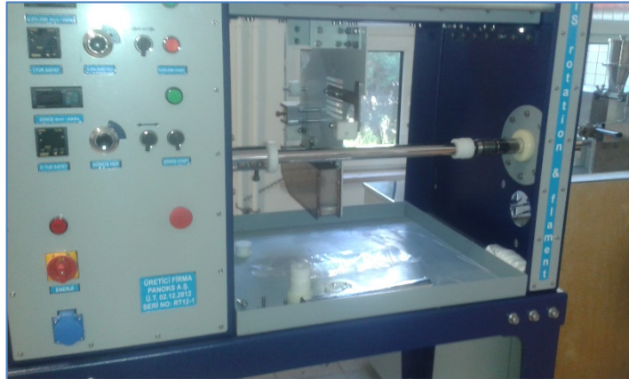
Görsel 3.1. Numune üretiminde kullanılan elyaf sarma cihazı
