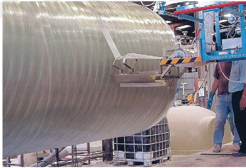
Görsel 2.11. İki eksenli bir elyaf sarma cihazı ile üretilen CTP boru örneği [37]
