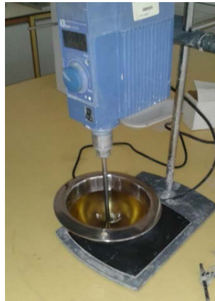
Görsel 3.3. 2 bileşenli reçinenin karıştırılmasında kullanılan karıştırıcı
