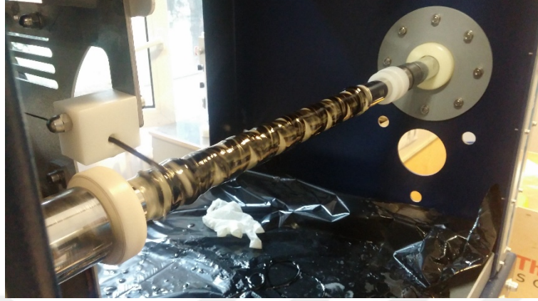
Görsel 3.5. Cam ve karbon elyaflardan oluşan melez kompozit silinir üretimi
