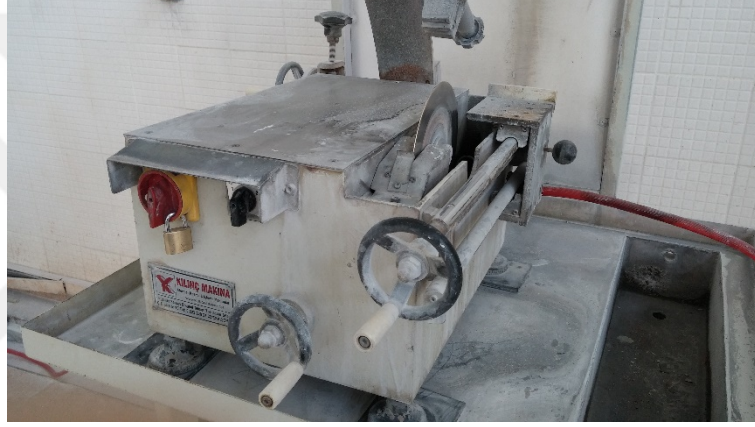
Görsel 3.9. Numune hazırlamada kullanılan sulu kesme cihazı
