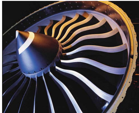
Görsel 2.2. GENx turbo fan motorunun karbon fiber/epoksi bıçakları (blade) [20]
