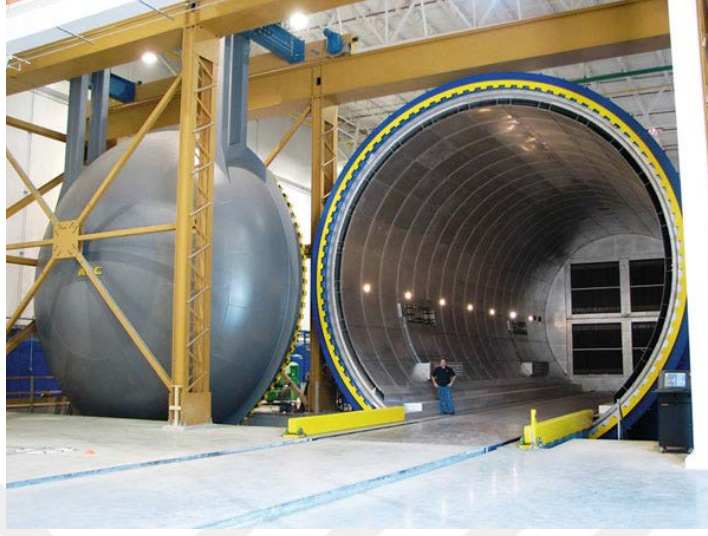
Görsel 2.10. Kompozit üretiminde kullanılan bir otoklav örneği [20]
