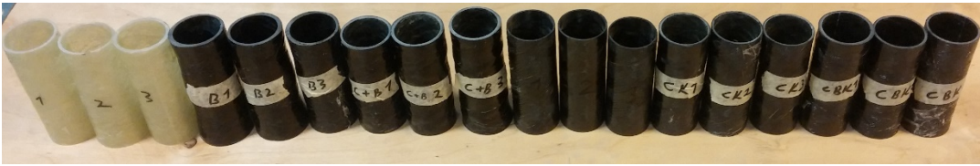
Görsel 3.11. ASTM D 2412 standardına uygun hazırlanmış numuneler
