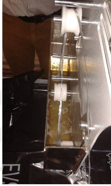
Görsel 3.4. Elyafın reçine havuzunda ıslatılması
