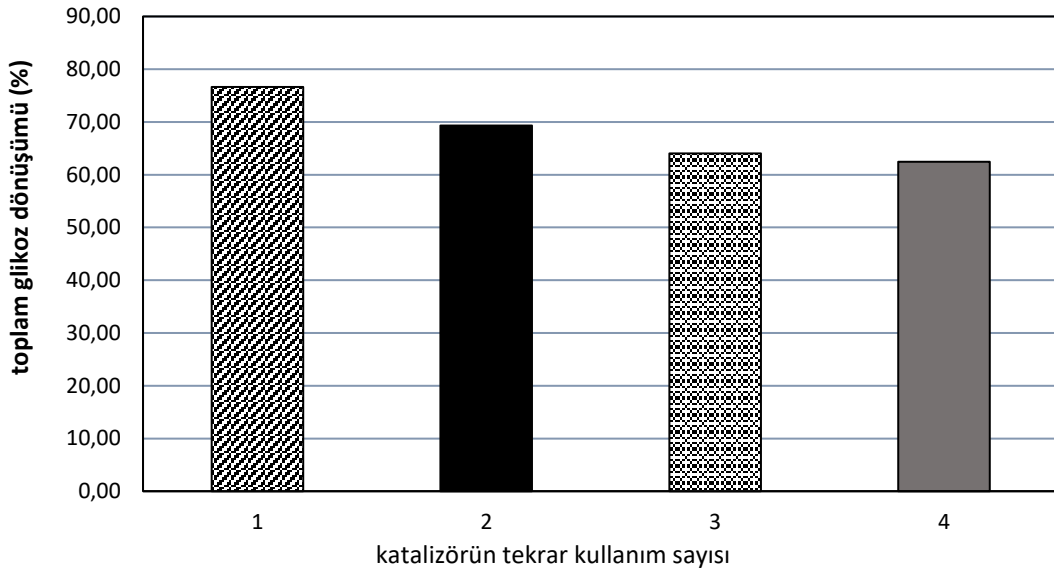
Şekil 112. 1/2 katalizör/katı oranında, 180 °C sıcaklıkta glikozun %5Cr-MMT katalizörü varlığında gerçekleştirilen katalitik dönüşüm işleminde katalizörün tekrar kullanımının glikozun toplam dönüşümüne etkisi
