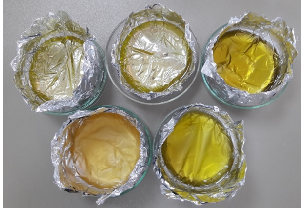
Şekil 4.10. Yağ analizi sonunda kurutulmak üzere folyolara dökülen türler
