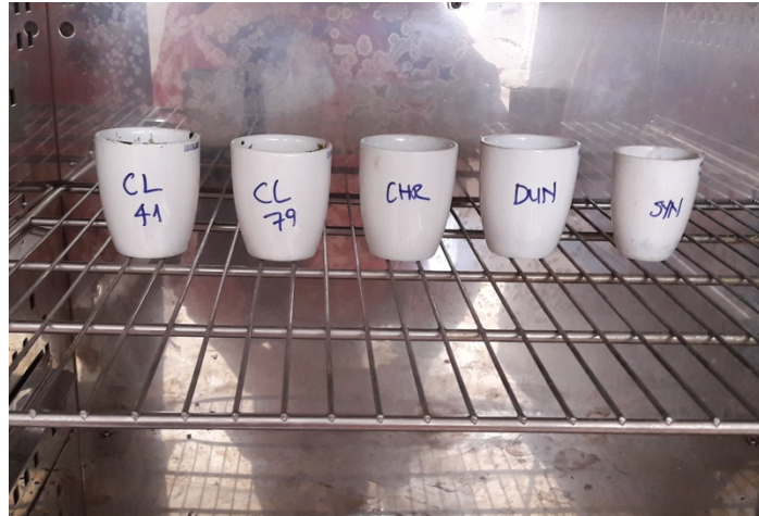
Şekil 4.13. Elementel analiz için türlerin etüvde kurutulması
