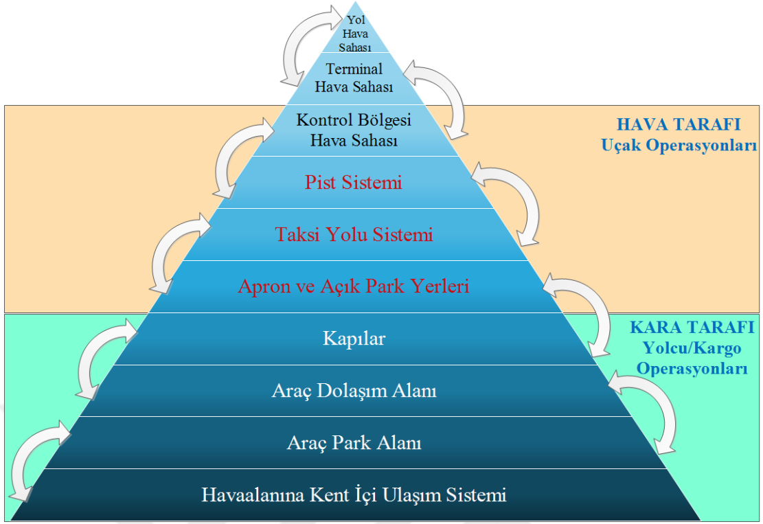
Şekil 1.1. Havaalanı sisteminin bileşenleri [3]
