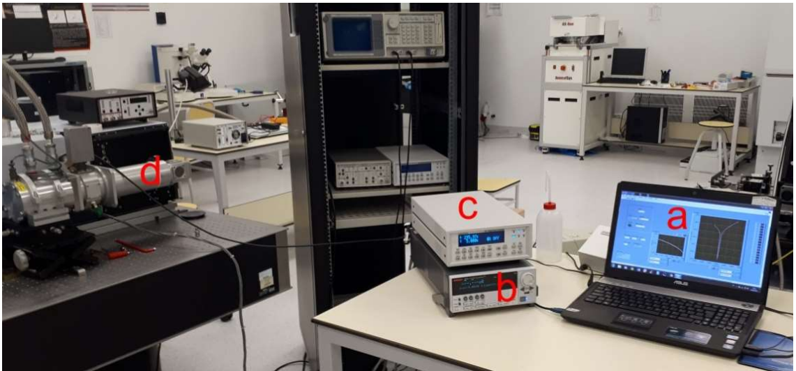
Görsel 3.14. Akım voltaj ölçüm düzeneği
