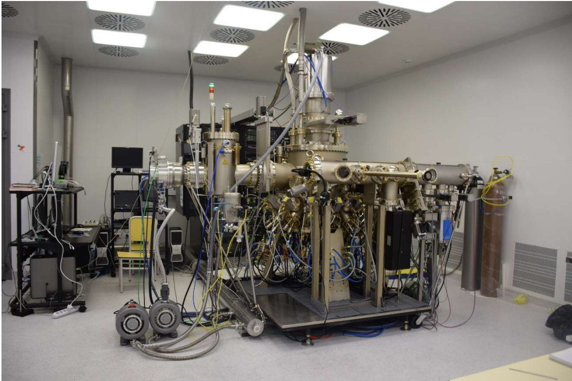
Görsel 3.1. MBE sistemi, Nanoboyut Araştırma Laboratuvarı
