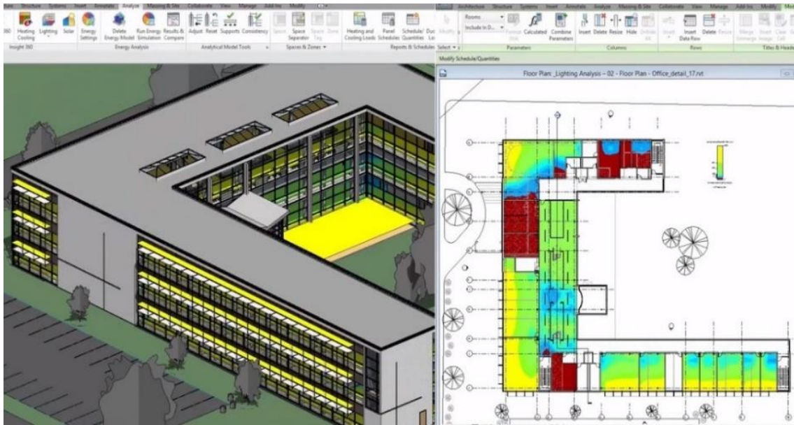
Görsel 2.6. Revit ile gün ışığı analizi (http-21) )
