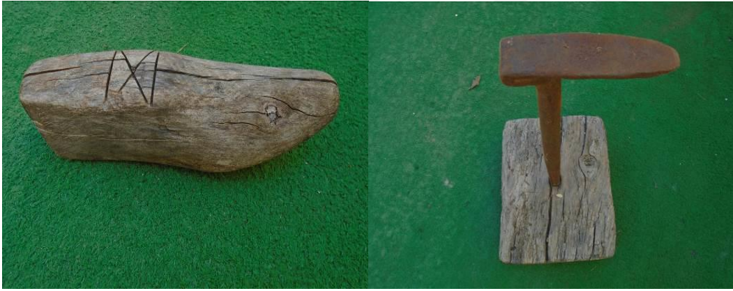
Görsel 3.29. Hisariçi Mahallesi 432 ada 2 parselde bulunan yemenici Halil İbrahim /Ali ve Halit İlhan’a ait yemeni kalıbı ve Örs (Akman, N)
