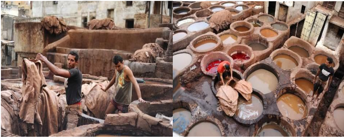
Görsel 3.35. Fas deri tabakhanelerinde yünleri ve kalıntıları temizlenmiş derilerin havuzda boyanması (Söylemez, H. 2016)
