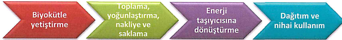
Şekil 2.5 Biyokütleden Enerji Üretiminin Aşamaları
