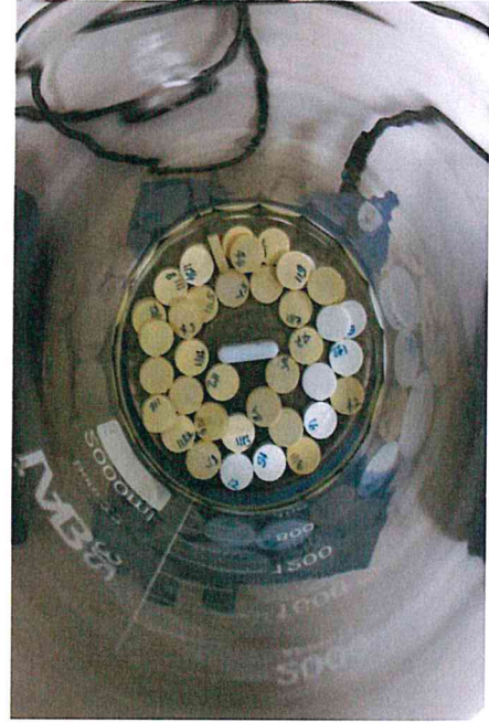
Şekil 3. 14 Su emdirme için kaynatma aşaması
