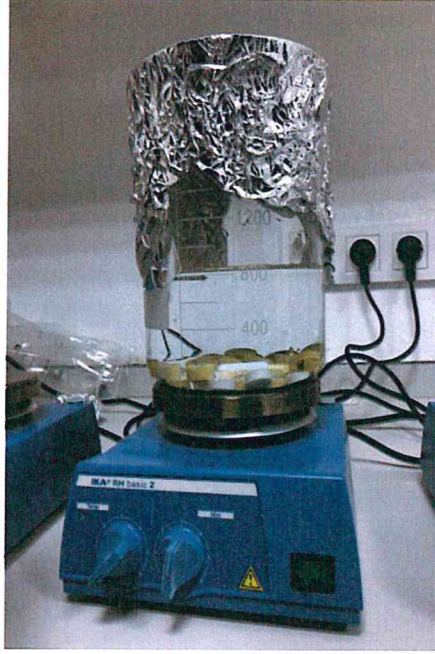
Şekil 3. 14 Su emdirme için kaynatma aşaması
