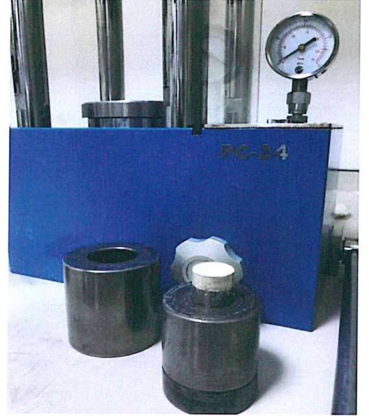
Şekil 3. 4 Kuru presleme yönteminde kullanılan pres ve elde edilen numune
