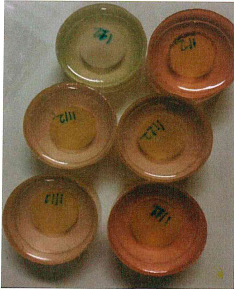
Şekil 3. 10 Soğuk kalıplanan numuneler ve kullanılan parlatma cihazı
