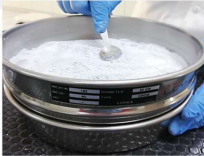
Şekil 3.7 Tozların elendiği 182 micronluk elek
