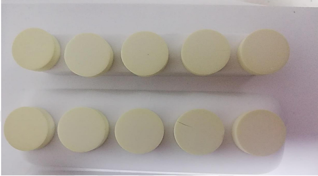
Şekil 3.19 1550°C 1saat sinterleme sonrası numunelerin görünümü
