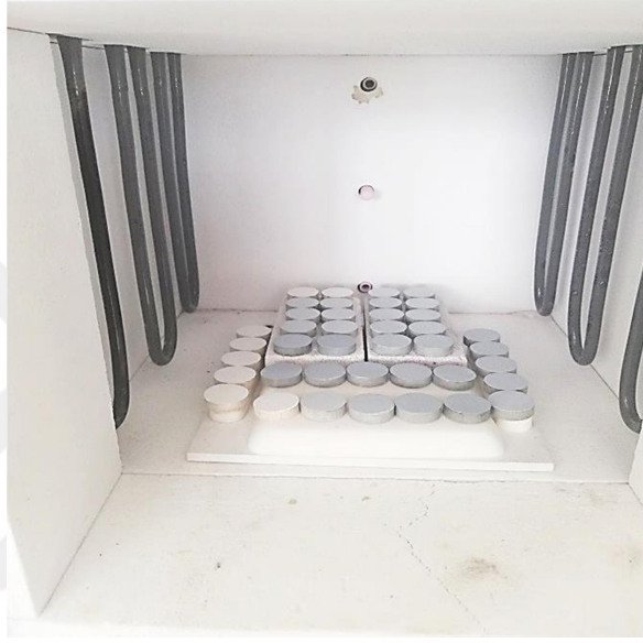
Şekil 3.17 Sinterleme için fırına yerleştirilen numunelerin görüntüsü
