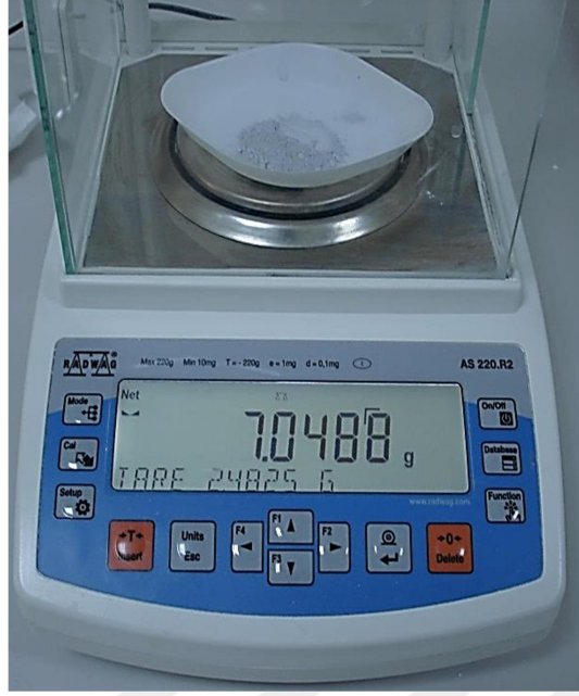
Şekil 3.8 RADWAG model hassas terazi
