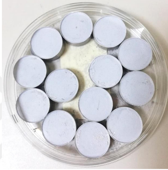
Şekil 3.11 Tek eksenli pres işlemi sonrasında elde edilen peletler
