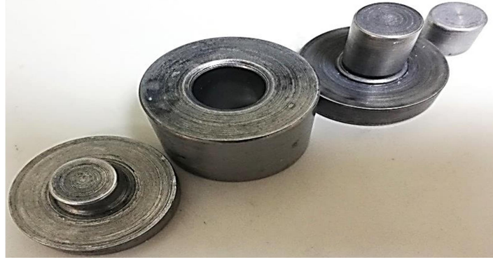
Şekil 3.10 Tozların yerleştirildiği pres kalıpları
