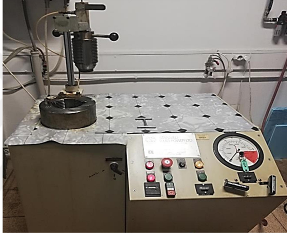
Şekil 3.14 Soğuk izostatik pres (CIP) cihazı
