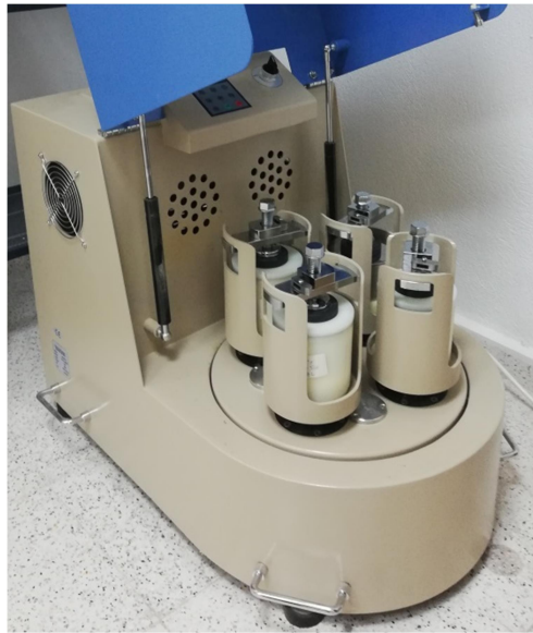
Şekil 3.3 Tozların karıştırıldığı gezegensel değirmenin hazneleri
