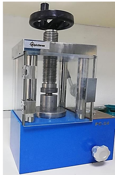
Şekil 3.9 Tek eksenli hidrolik pres
