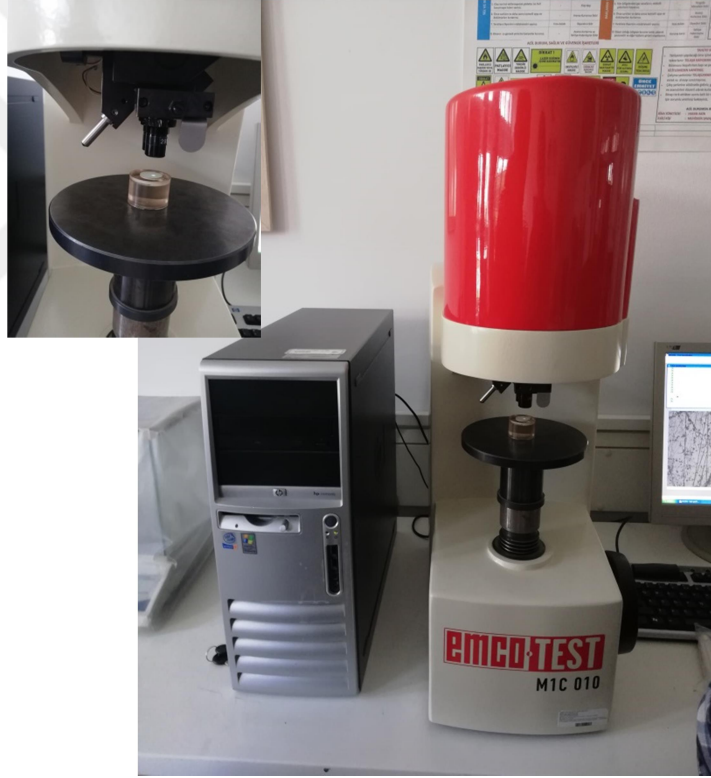
Şekil 3.33 Emco Test MIC 010 model vickers sertlik ölçüm cihazı
