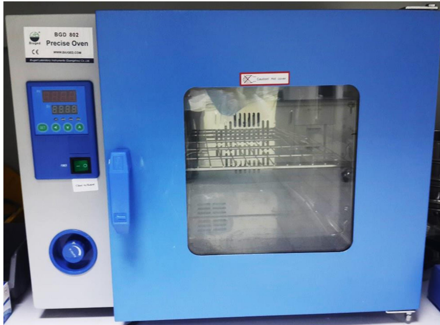
Şekil 3.5 BGD-802 model hassas etüv fırını
