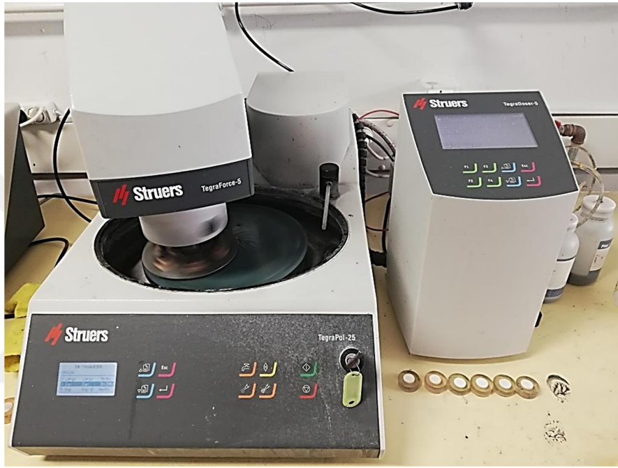
Şekil 3.30 Struers TegraPol-25 marka otomatik parlatma cihazı
