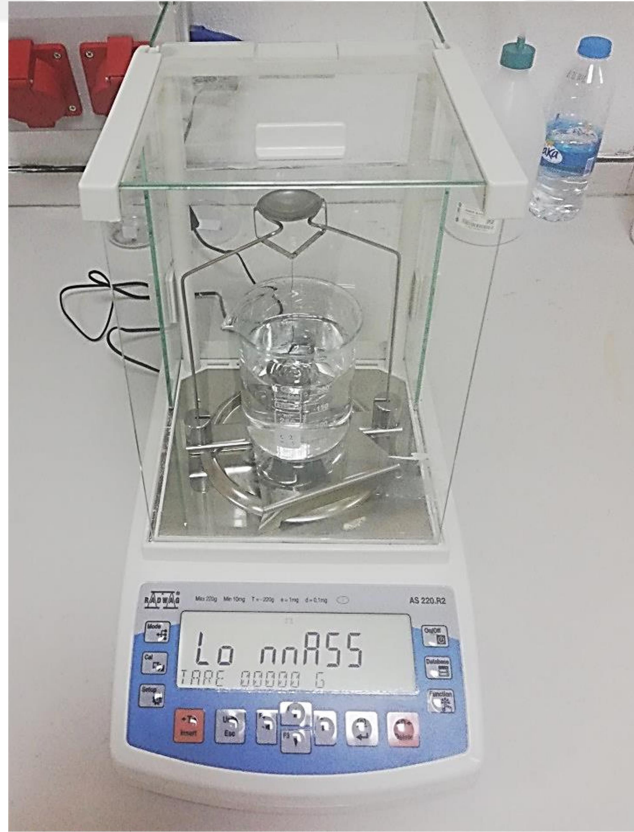
Şekil 3.27 Arşimet ölçümü için hazırlanmış hassas terazi
