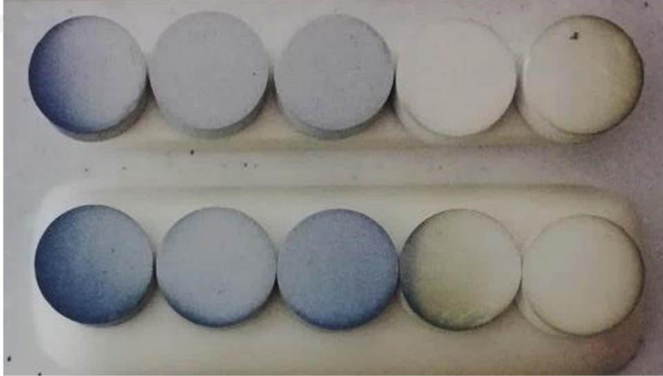
Şekil 3.16 Bağlayıcı uzaklaştırma sonrası numunelerin görünümü
