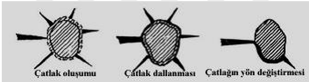
Şekil 2.8 Tetragonal-monoklinik faz dönüşümü sırasında mikro çatlak oluşumu ve ilerleyen bir çatlağın dallanması veya yön değiştirmesi (Stevens, 1986)
