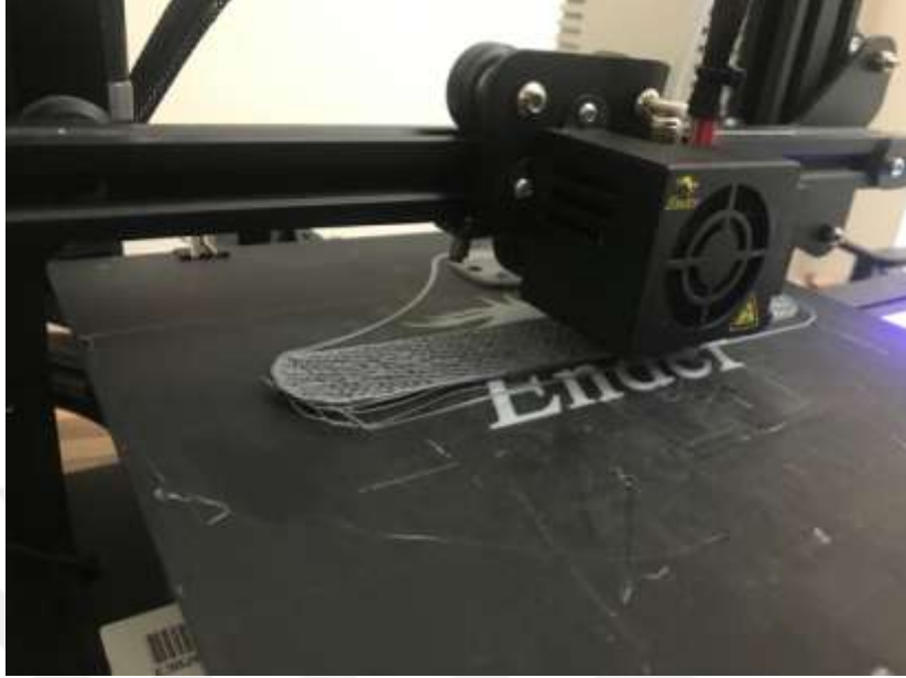
Şekil 2.9 İlk katmanlarda sıkça oluşan eğilme kalkma sorunu
