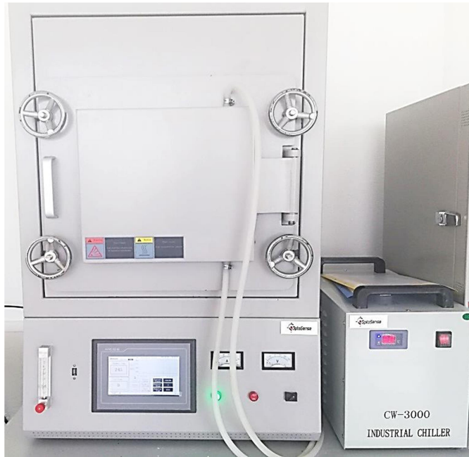
Şekil 3.17 Sinterleme işlemi için kullanılan optosense marka fırın
