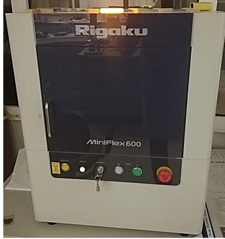
Şekil 3.35 X-ışını kırınımı (XRD) analizi için kullanılan cihaz
