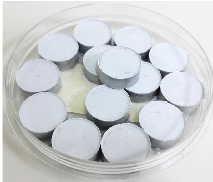
Şekil 3.10 Presleme işlemi sonrasında elde edilen peletler
