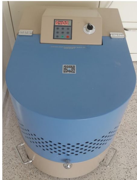
Şekil 3.3 MSK-SFM-1 model gezegensel değirmenin dış görüntüsü
