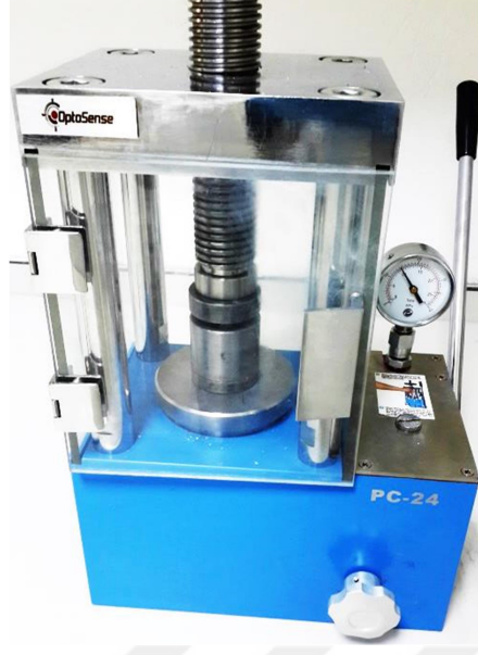
Şekil 3.8 Pelet basımında kullanılan tek eksenli hidrolik pres
