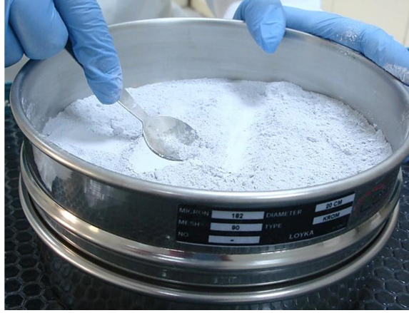
Şekil 3.6 Tozların elendiği 182 micron'luk elek
