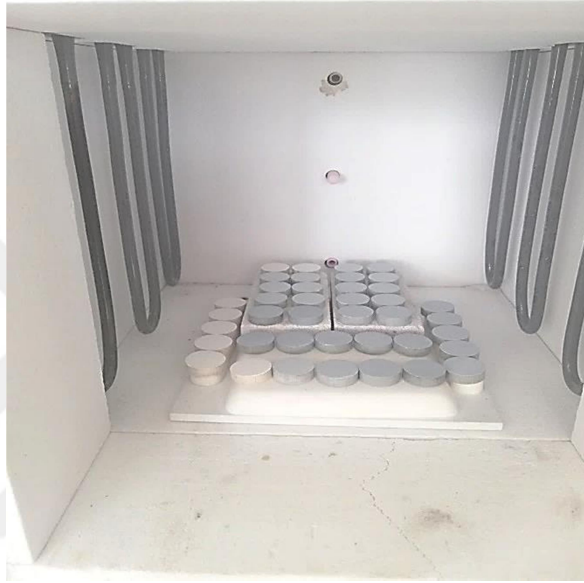
Şekil 3.16 Sinterleme işlemi için hazırlanmış numunelerin görüntüsü
