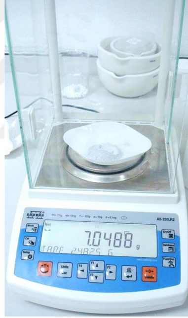
Şekil 3.7 Tozların tartımında kullanılan RADWAG marka hassas terazi
