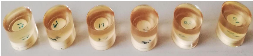
Şekil 3.28 Kalıptan çıkarılmış bakalit halindeki numuneler
