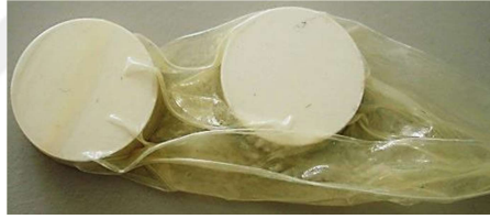
Şekil 3.12 Lateks kılıf içerisindeki numunelerin görünümü
