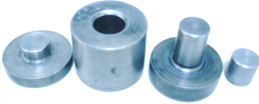
Şekil 3.9 Presleme işleminde kullanılan kalıplar
