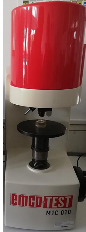
Őekil 3.32 Sertlik lmnde kullanılan Emco Test M1C 010 model cihaz
