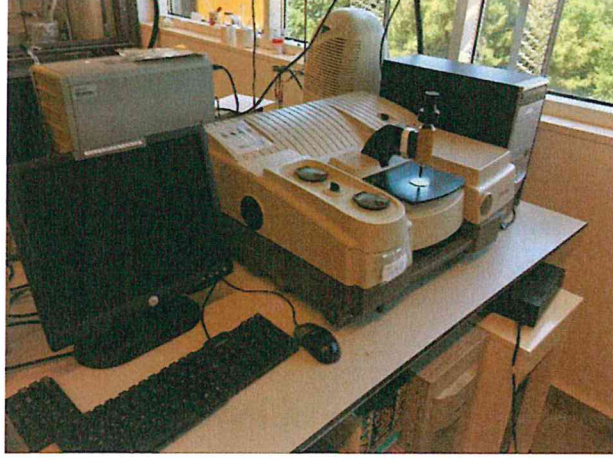
Şekil 3.8 FT-IR analizi için kullanılan cihaz
