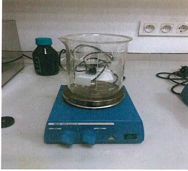
Şekil 3.2. Sentez aşamasında kullanılan manyetik karıştırıcı
