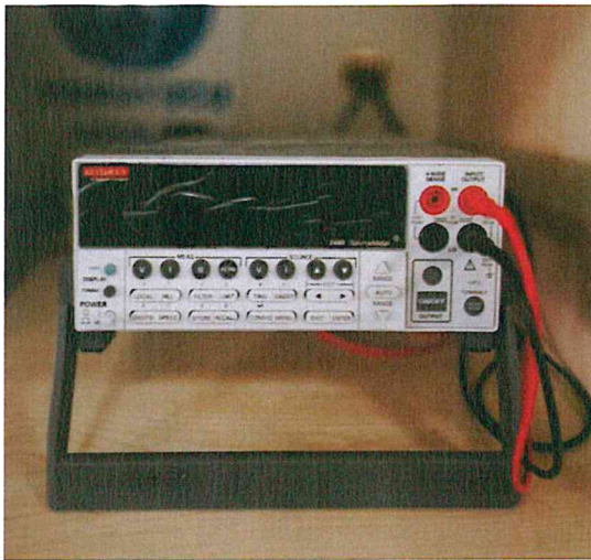
Şekil 3.7 Verim ölçümü için kullanılan Solar Simülatör-Keithley cihazlarının görüntüsü
