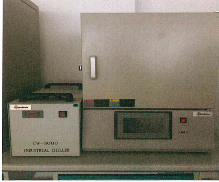
Şekil 3.4 Kalsine işleminde kullanılan fırın
