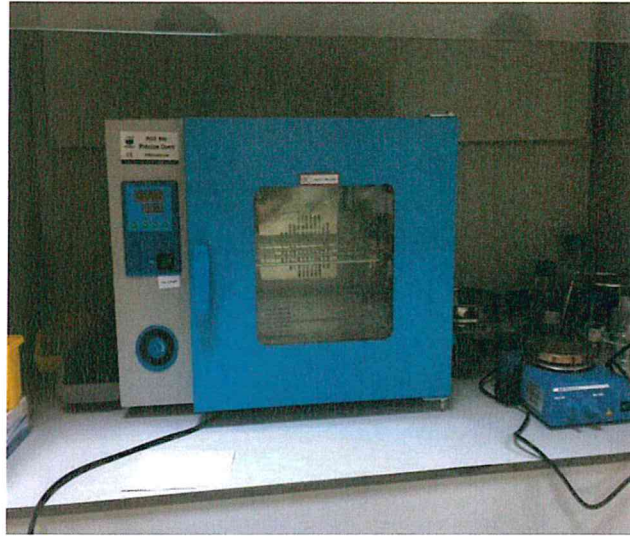
Şekil 3.3. Kurutma aşamasında kullanılan etüv
