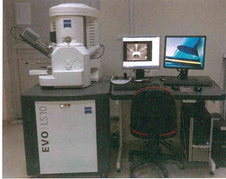
Şekil 3.6 Morfolojik işlem için kullanılan SEM-EDX cihazının görüntüsü
