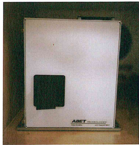
Şekil 3.7 Verim ölçümü için kullanılan Solar Simülatör-Keithley cihazlarının görüntüsü
