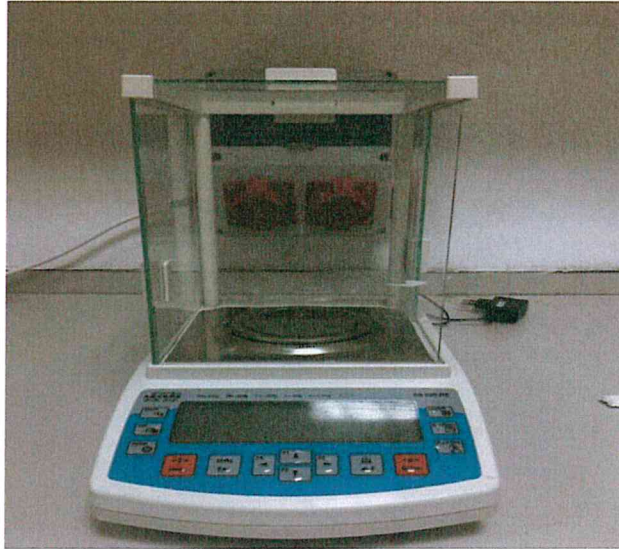
řekil 3.1. Tartım için kullanılan hassas terazi
