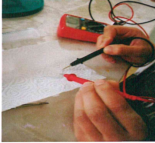
Şekil 3.18 Voltmetre ile iletken cam yüzey kontrolü
