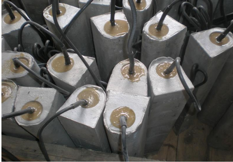
Şekil 3.20 H.pot Mg anot ve kabloları
