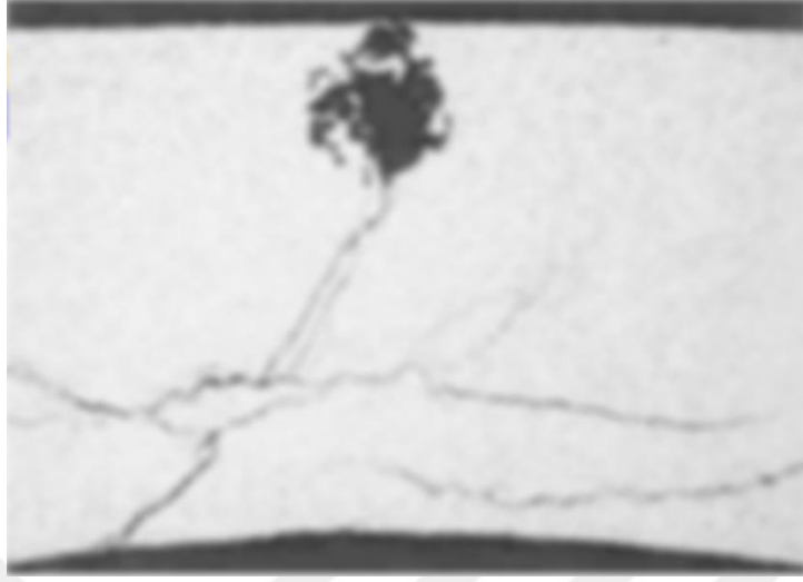
Şekil 2.34 Çekme gerilmelerine maruz kalan çelik maddenin korozif ortamın etkisi nedeniyle gerçekleşen gerilmeli tip korozyonun mikroskobik görünümü
