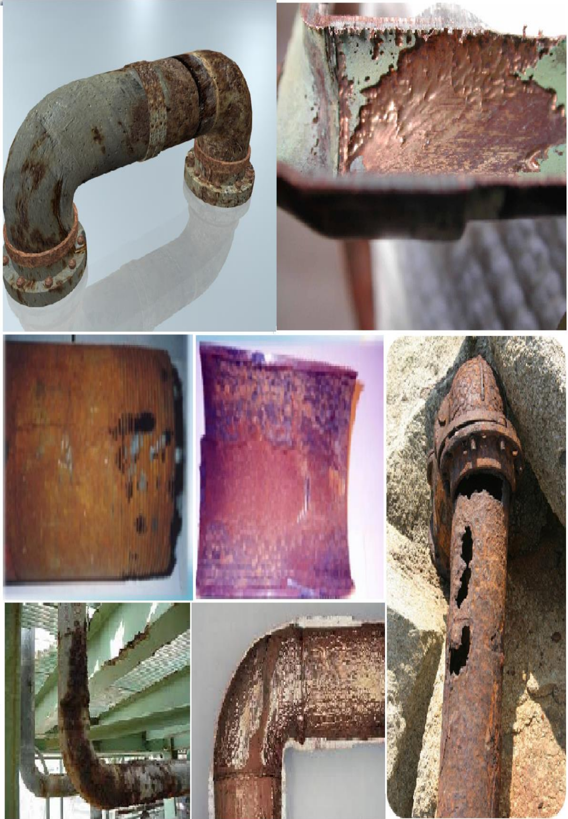
Şekil 2.19 Çeşitli malzemelerden üretilmiş boru iç yüzeyinden başlayan erozyon korozyonunun ilerleyerek borunun dış yüzeyini delmesine kadar geçen süreç
