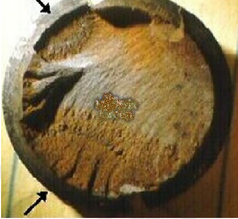
Şekil 2.37 Dişlilerde oluşan yorulmalı tip korozyonun temas sonucu çatlama örneği
