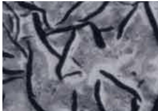
Şekil 2.9 Gri dökme demirde grafitleşme görüntüsü
