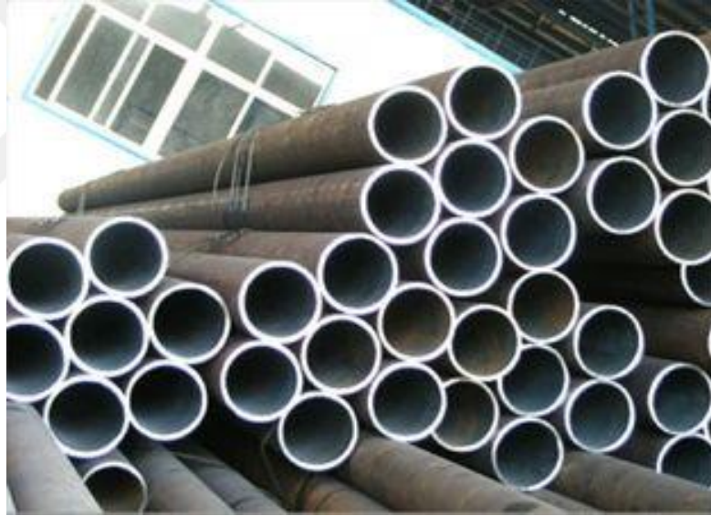
Şekil 3.19 Örnek proje kapsamında kullanılacak 6” borular
