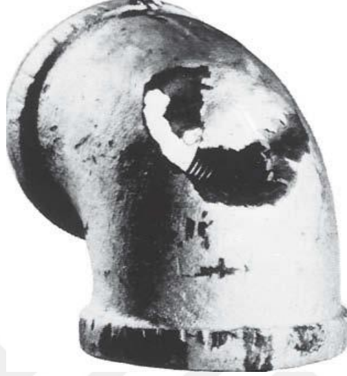
Şekil 2.18 Buhar iletim hattında bulunan dirseğin darbelere karşı dayanıksızlığı (Fontana, 1986)
