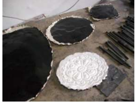
Şekil 61-Kabartma uygulamasında kullanılan macun
