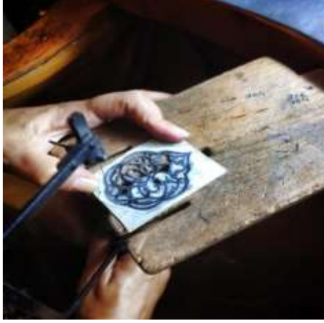
Şekil 52-Kıl Testereyle Metal Plaka Kesme İşlemi
